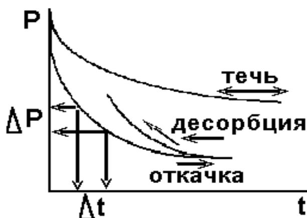
Рисунок 2.2 – Кривые откачки для анализа вакуумной системы
