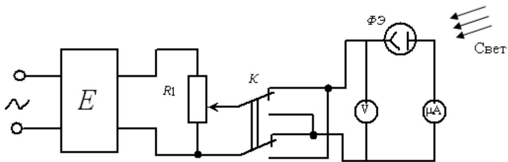
Рисунок 4.2 – Схема экспериментальной установки
