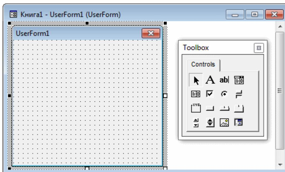
Рис. 12 Окно редактирования форм и панель инструментов
