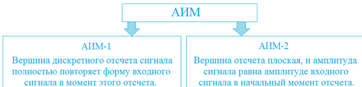
Рисунок 1.4 – Виды амплитудно-импульсной модуляции
