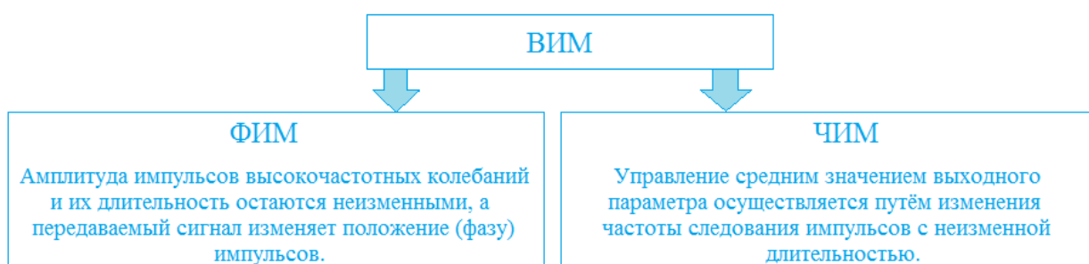
Рисунок 1.13 – Виды время-импульсной модуляции
