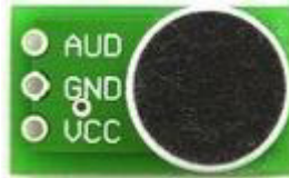
Рисунок 15 – Схема выводов на плате микрофона.
