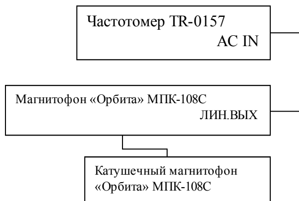
Рис. 2. Схема соединения элементов установки для измерения средней скорости движения магнитной ленты
