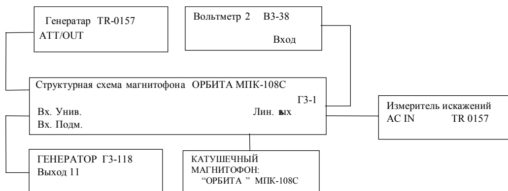
Рис. 4 Схема соединения элементов установки для снятия зависимости коэффициента гармоник от тока подмагничивания "ПАУЗА".
