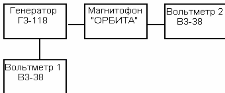
Рис.1 Структурная схема установки для снятия амплитудно-частотных характеристик усилителя воспроизведения и сквозного канала магнитофона
