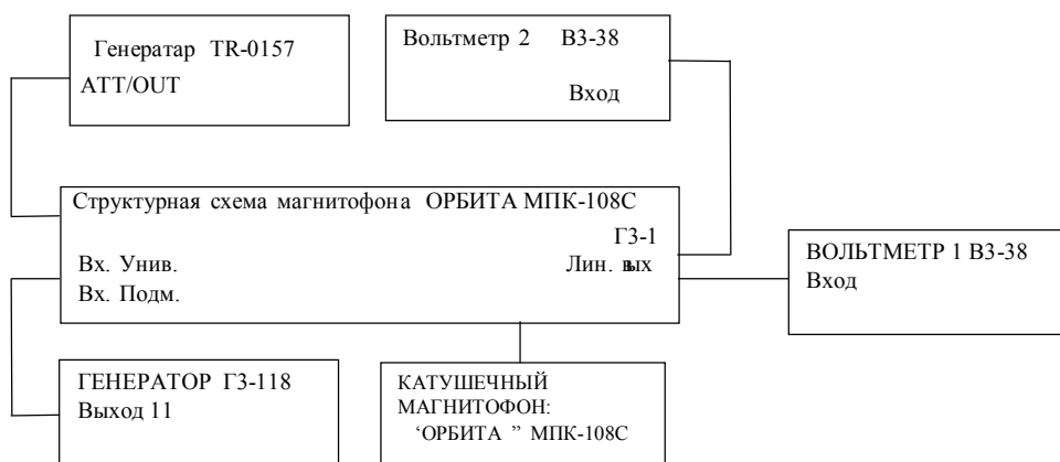
Рис 3. Схема соединения элементов установки для снятия зависимости отдачи магнитной ленты от тока подмагничивания.
