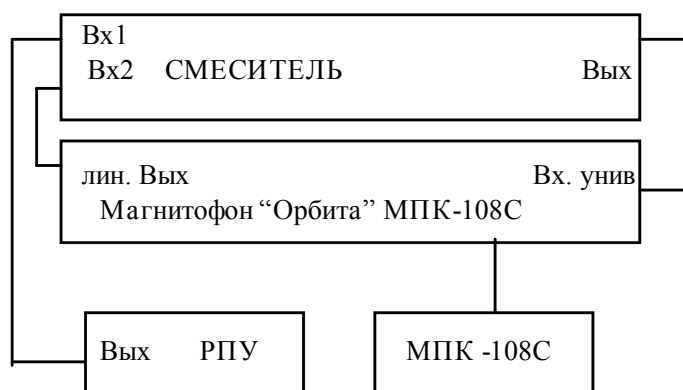
Рис. 11. Схема соединения элементов установки для изучения магнитного ревербератора
