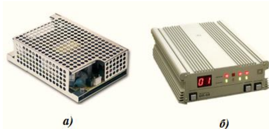
Рис. 2.9 - Виды корпусов РЭС с интенсивным тепловыделением: а) - с перфорацией стенок; б) - с оребрением стенок
