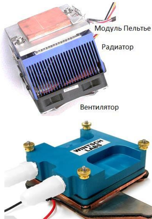
Рис. 2.12 – Системы базе модулей Пельтье: а) воздушное; б) жидкостное (видеокарта GeForce 6800 компании Ultra Arctic Spider мощностью 437 Вт, на который установлен водоблок. Система дополнительно потребляет 600 Вт)
