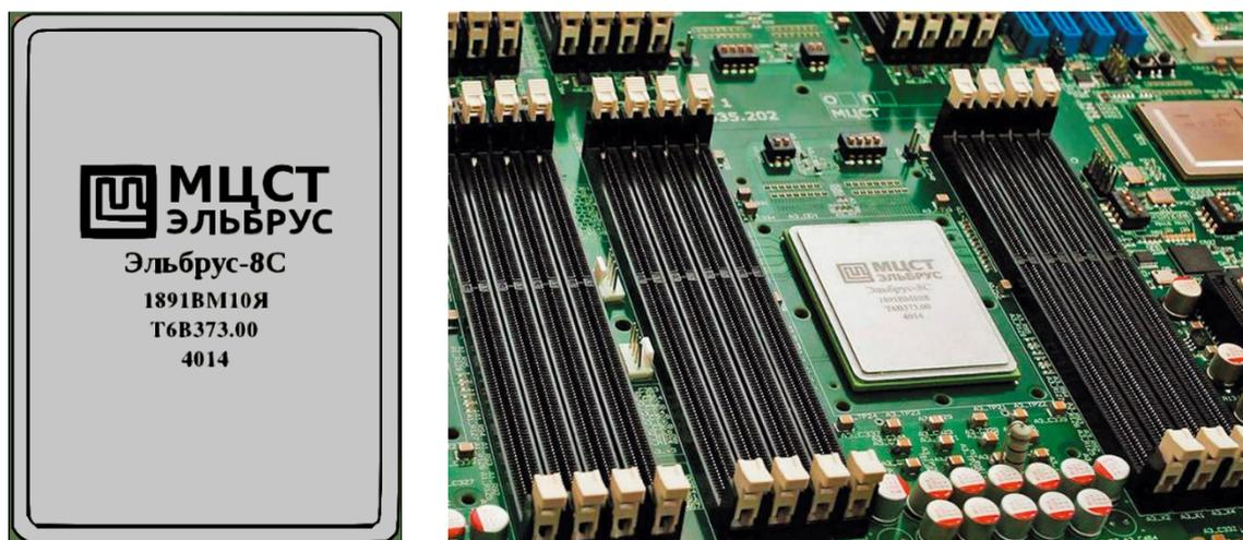
Рис. 1.2 - Кристалл отечественного микропроцессора «Эльбрус-8С» компании МЦСТ спроектирован по технологии 28 нм, имеет 8 процессорных ядер.
