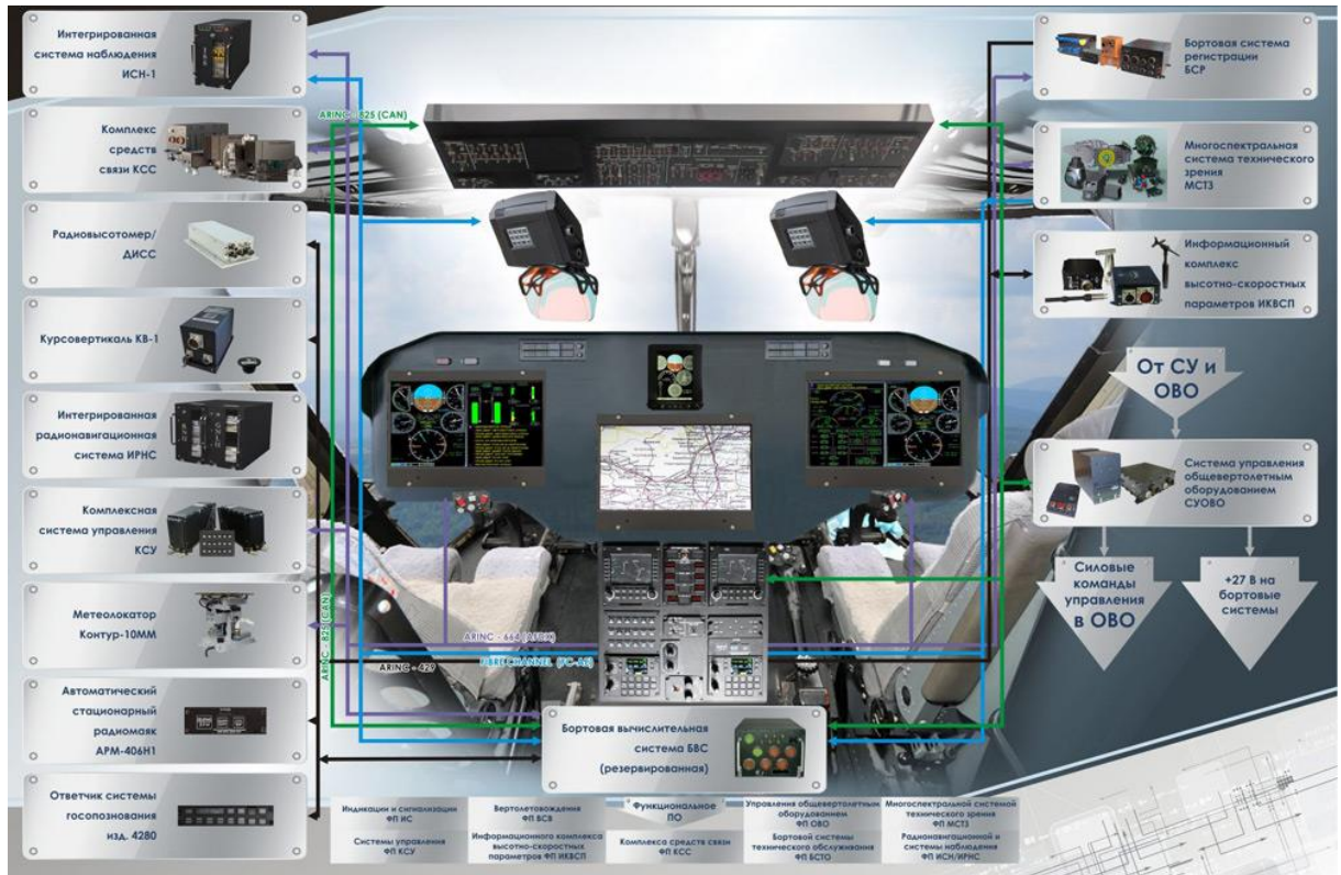
Рис. 5.12 - Комплекс бортовых подсистем перспективного российского скоростного вертолета пятого поколения [55]
