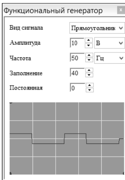
Рис. 2.1. Лицевая панель функционального генератора
