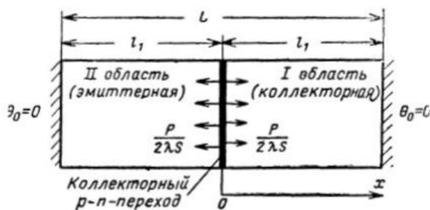
Рисунок 11. Симметричная теплофизическая модель сплавного транзистора (по Мартенсону)
