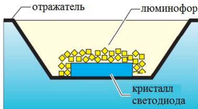
Рисунок 3.3 – Ближнее конформное расположение люминофора
