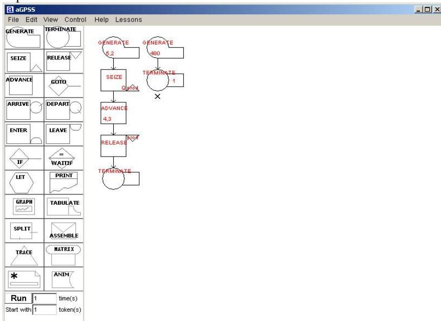
Запускать программу на выполнение можно ТОЛЬКО путем нажатия кнопки «RUN», после того как будет построена блочная диаграмма.
