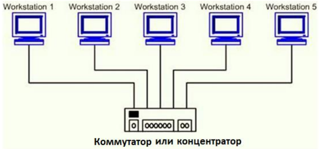
Рис. 5.14 - Сеть с топологией типа ЗВЕЗДА
