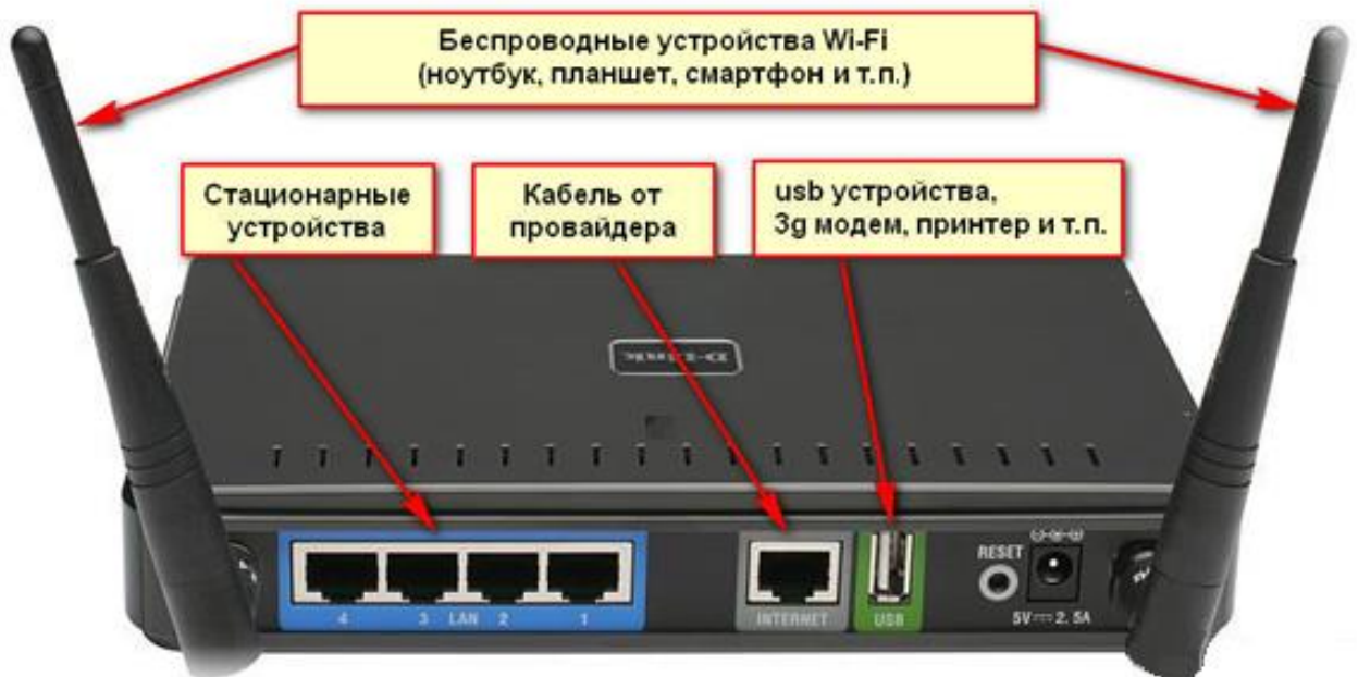
Рис. 5.5 – Беспроводной домашний Wi-Fi роутер, позволяющий объединить все домашние компьютеры в одну локальную сеть с доступом к Интернету
