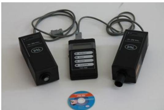
Рисунок 2 – Спектроколориметр «ТКА-ВД» Предназначен для измерения спектральных характеристик источников оптического излучения координат цветности  $x, y, u, v$ , координат цвета  $X, Y, Z$ , коррелированной цветовой температуры  $T_c$ .
