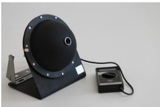
Рисунок 1 – Измеритель светового потока «ТКА-КК1» предназначен для измерения полного светового потока светодиодов в видимой области спектра (от 380 до 780 нм) по методу «интегрирующей сферы»
