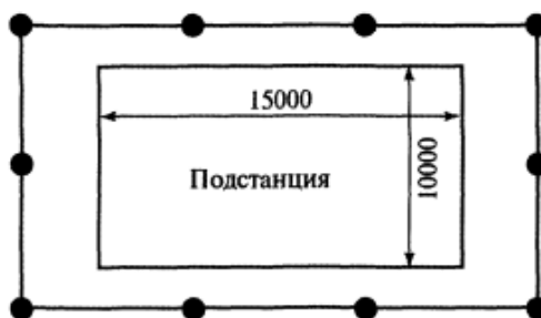
Рисунок 1.54 – Схема контурного заземлителя понижающей трансформаторной подстанции 10/0,4 кВ
