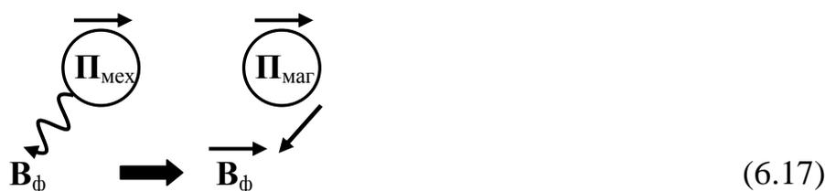
Такая схема реализована, например, в магнитных подъемниках-кранах, магнитных переносчиках и т.п. Однако, исходный неполный веполь здесь не достраивается; он остается неполным веполем, но с другим полем. Простая замена поля не дает четко выраженного нового эффекта. Такие решения сегодня уже не являются изобретательскими, хотя, еще 50 лет назад они могли считаться оригинальными, творческими.
