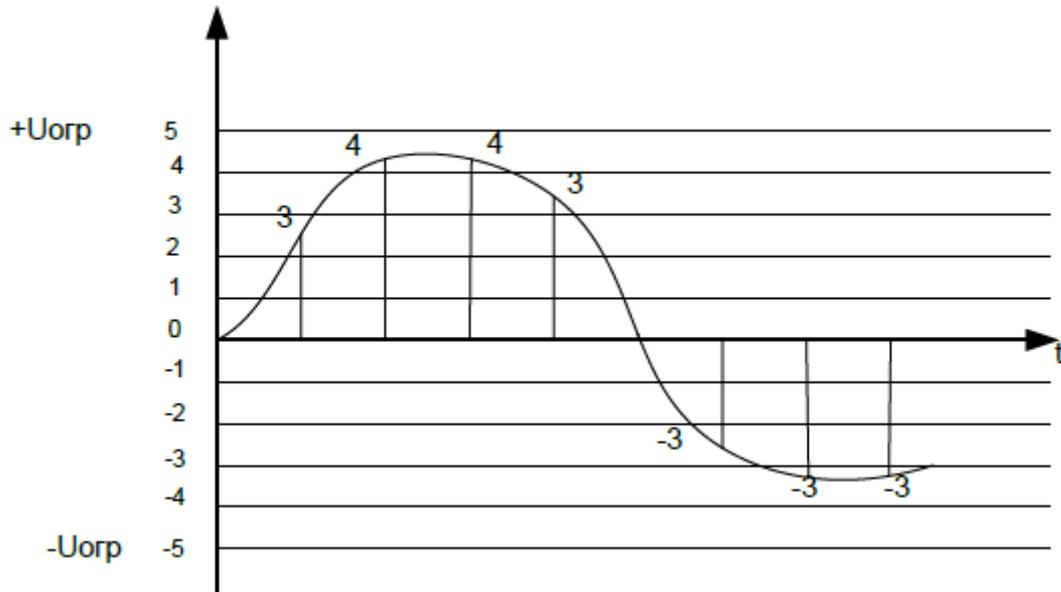
Рисунок 1.6 – Характеристика симметричного кодирования
