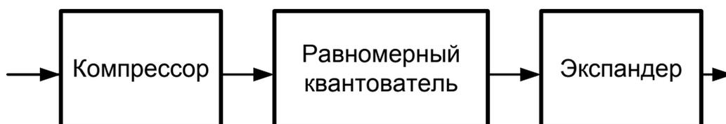
Рисунок 2.2 — Структурная схема устройства неравномерного квантования с компандированием аналогового сигнала
