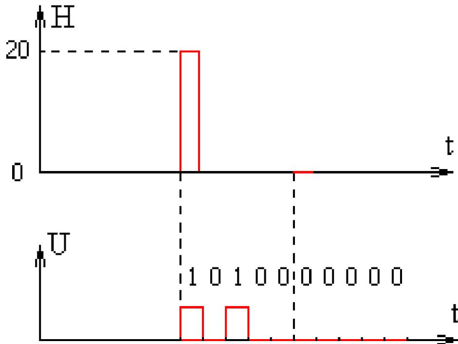
Рисунок 1.2.9 – Кодовые комбинации, полученные в результате кодирования
