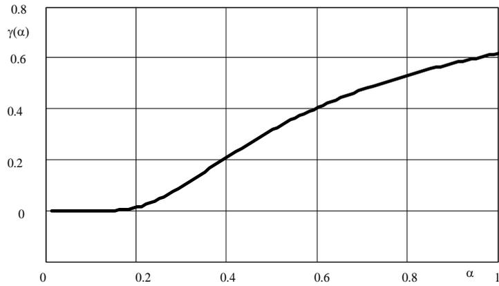
Рисунок 3.5 – Зависимость коэффициента уширения  $\gamma$  от параметра  $\alpha$  сигнала гауссовой формы
