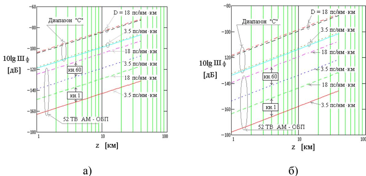
Рисунок 4.2 – Зависимость от длины ОВ мощности шумов интенсивности ЛД
