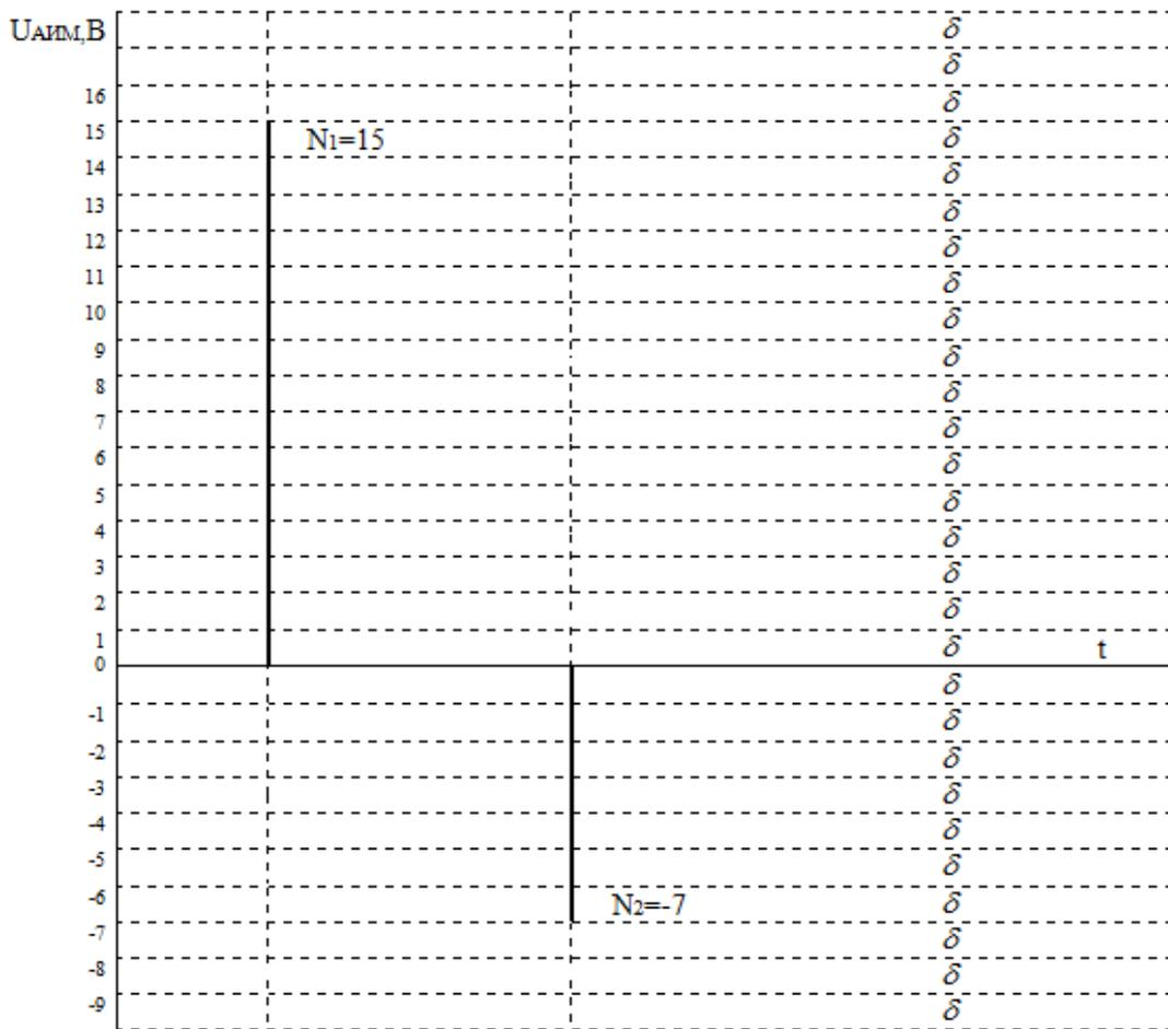
Рисунок 1.2.2 – Результат равномерного квантования
