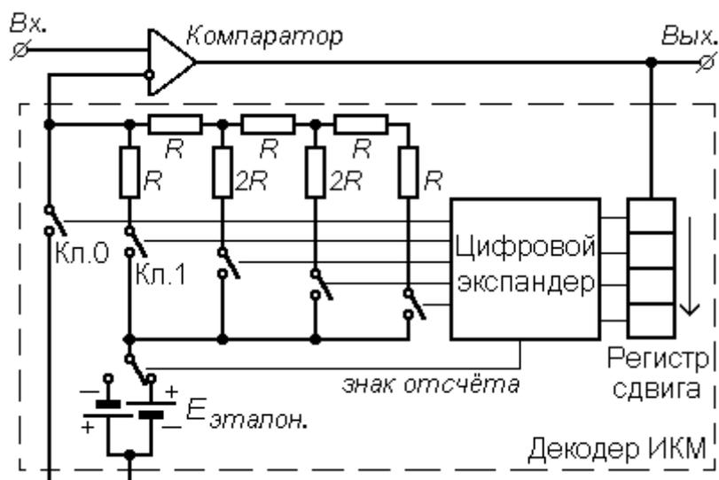
Рисунок 2.7 – Функциональная схема кодера ИКМ-64 с А-законом компандирования
