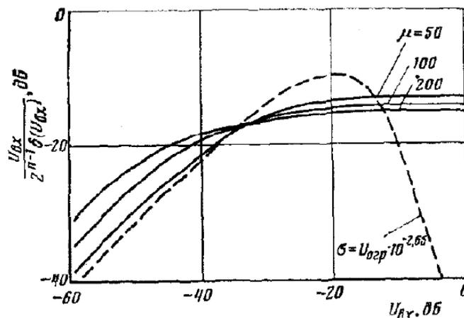
Рисунок 2.4 – Зависимость  $\frac{U_{\text{ex}}}{\delta(U_{\text{ex}})}$  от величины входного сигнала.
