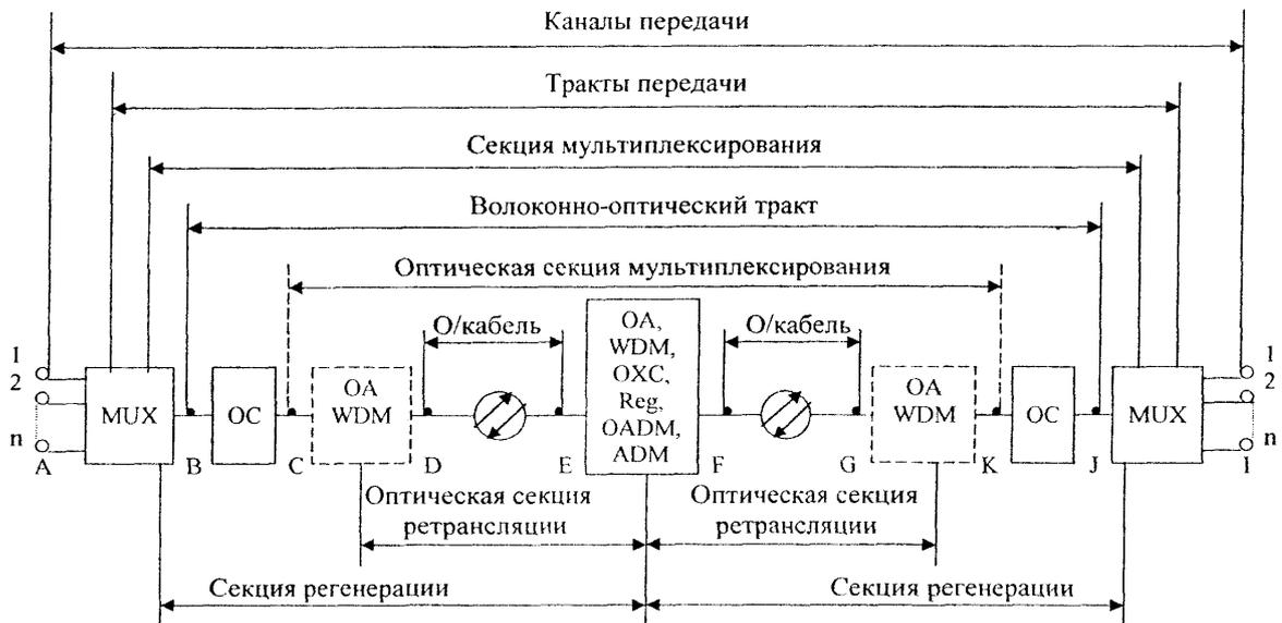
Рисунок 3.10 – Схема участка цифрового линейного тракта.
