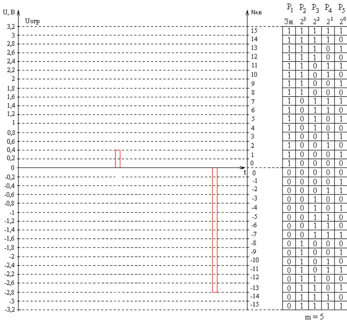
Рисунок 1.2.6 – Отсчёты, квантованные по уровню для симметричного двоичного кода
