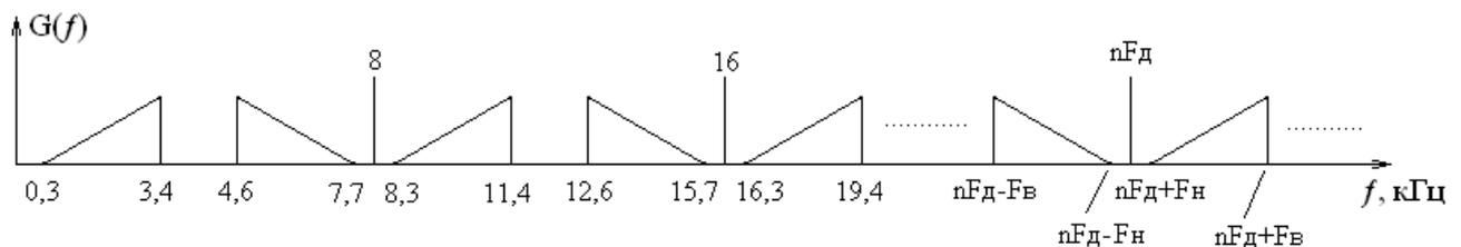
Рисунок 1.2.4 – Спектр АИМ – сигнала при  $F_\delta = 8$  кГц
