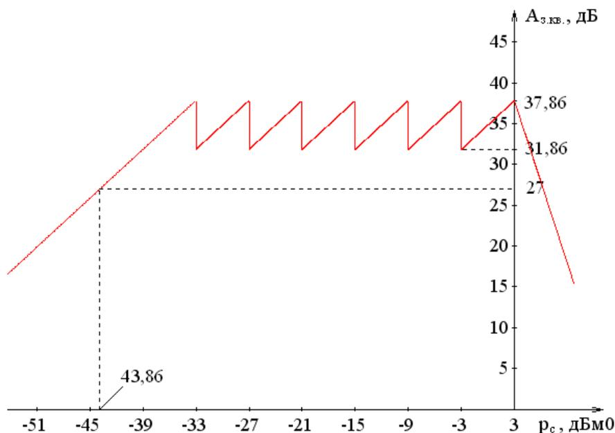
Рисунок 1.2.11 – Зависимость  $A_{пз.кв.} = f(p_c)$  при неравномерном квантовании для гармонического сигнала
