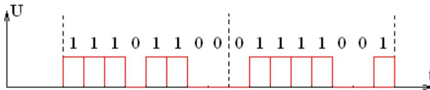
Рисунок 2.12 – Кодовые комбинации, полученные в результате кодирования.
