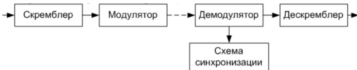
Рисунок 6.1 – Схема включения скремблера и дескремблера в канал связи
