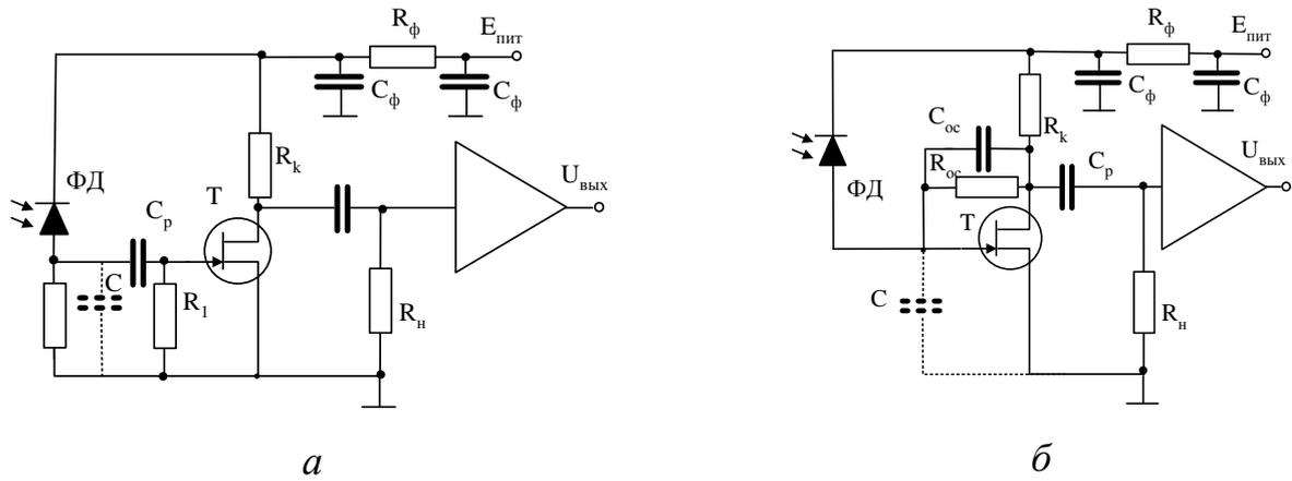
Рисунок 3.7 – Разновидности типов ПУ
