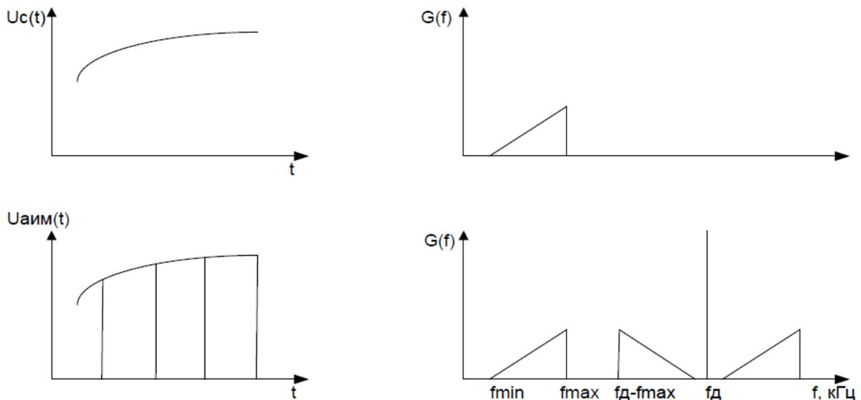
Рисунок 1.1 – Дискретизации непрерывного сигнала по времени и его спектр
