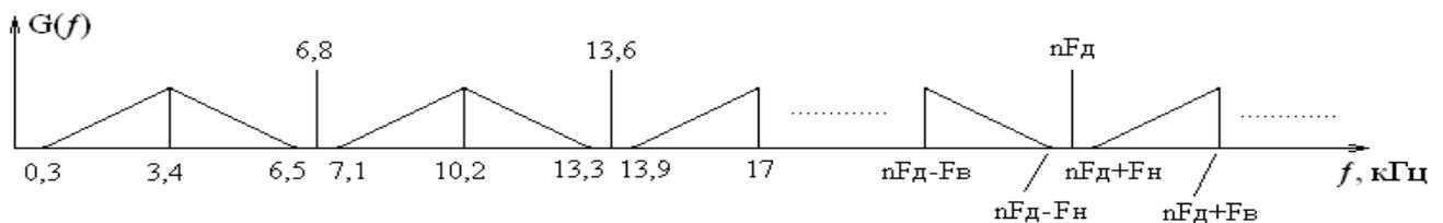
Рисунок 1.2.3 – Спектр АИМ – сигнала при  $F_\delta = 6,8$  кГц
