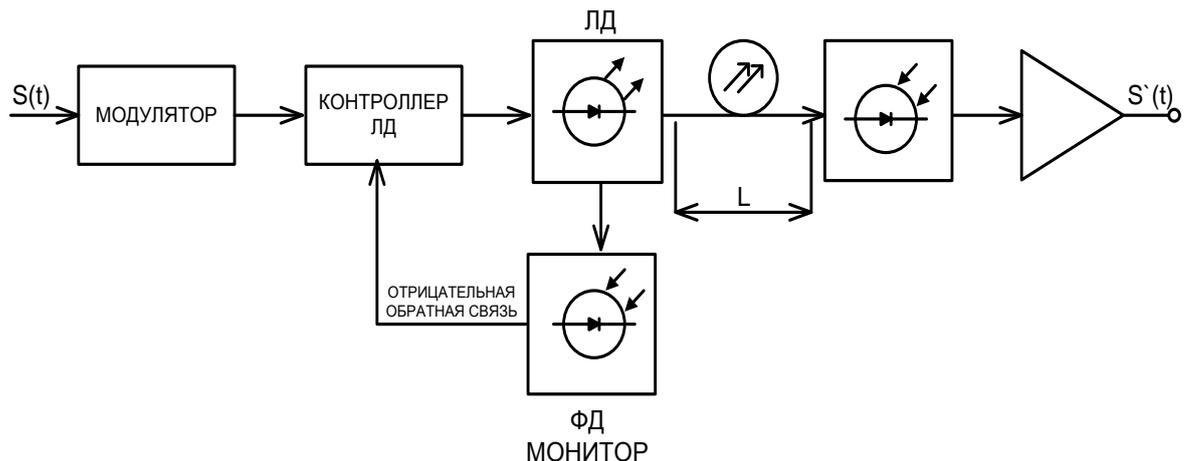
Рисунок 4.1 – Структурная схема аналоговой волоконно-оптической системы передачи.
