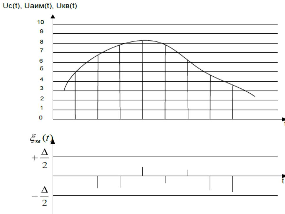
Рисунок 1.3 – Дискретизация исходного сигнала по времени и квантование непрерывных отсчетов по уровню
