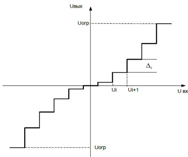
Рисунок 1.4 – Неравномерное квантование
