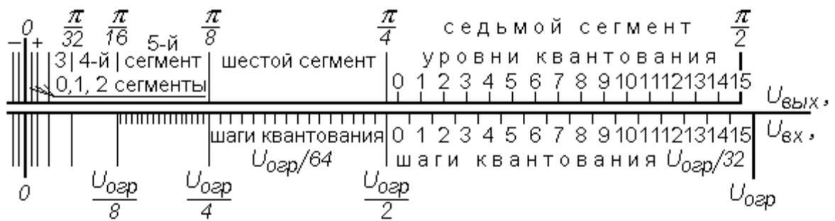
Рисунок 2.5 – Шкала непрерывного  $U_{вх}$  и квантованного  $U_{вых}$  напряжений
