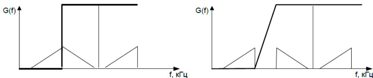
Рисунок 1.2 – Восстановление непрерывного сигнала в тракте приема
