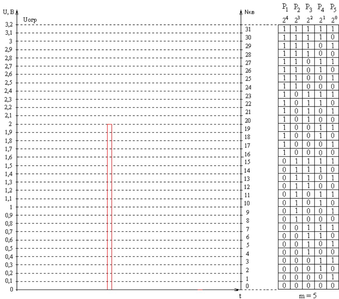
Рисунок 1.2.8 – Отсчёты, квантованные по уровню для натурального двоичного кода
