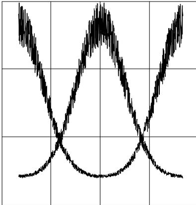
с предварительным усилителем, выполненным на основе  $Si$  – ПТШ, приведена на рисунке. Считая, что сквозная АЧХ ПРОМ  $H(f)$  имеет вид «приподнятого косинуса», оценить уровень коэффициента ошибок данной системы.
