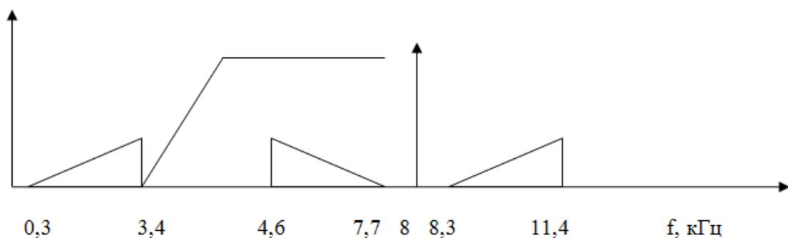
Рисунок 1.2.1 – Спектр сигнала
