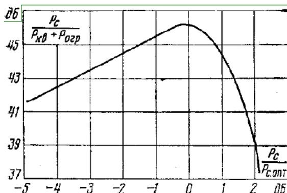
Рисунок 2.1 – Зависимость отношения сигнал-шум от уровня сигнала с нормальным законом распределения мгновенных значений
