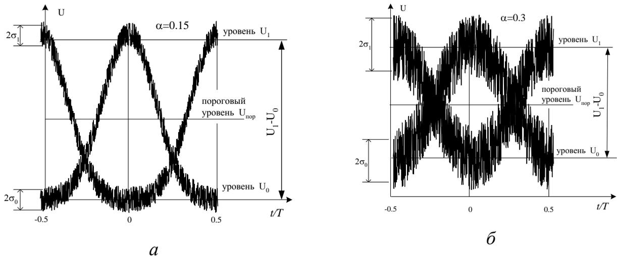
Рисунок 5.1 – Глаз-диаграммы линейного сигнала гауссовой формы
