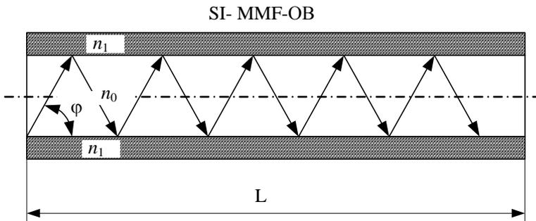
Мода низшего порядка распространяется под углом скольжения  $\phi_{\text{кр}}$  равным критическому, т.е. максимальному углу  $\phi$ , при котором волноводная мода еще не выходит за пределы сердцевины ОВ.
