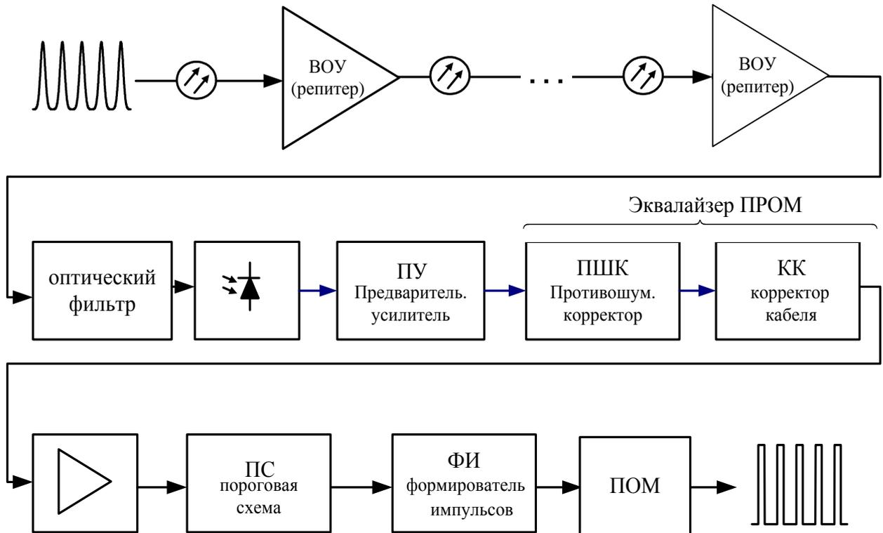
Рисунок 3.1 – Блок схема линейного регенератора
