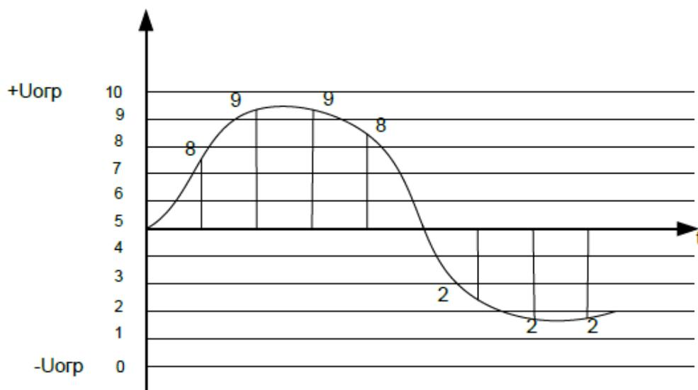
Рисунок 1.4 – Характеристика натурального кодирования
