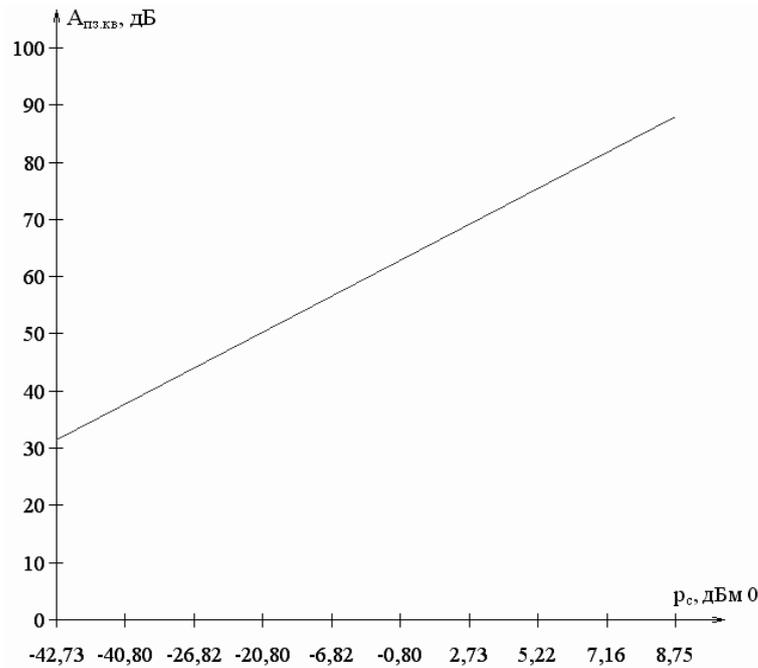
Рисунок 1.2.10 – Зависимость  $A_{з.кв.} = f(p_c)$  при равномерном квантовании
