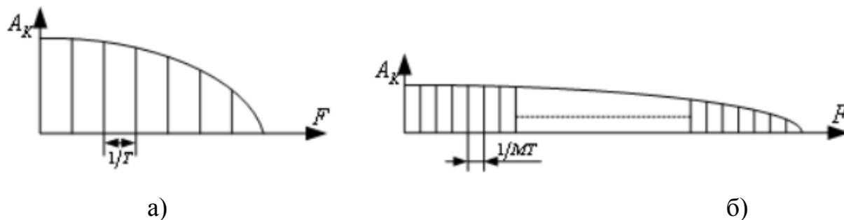
Рисунок 6.3 – Спектр сигнала: а) до скремблирования; б) после скремблирования
