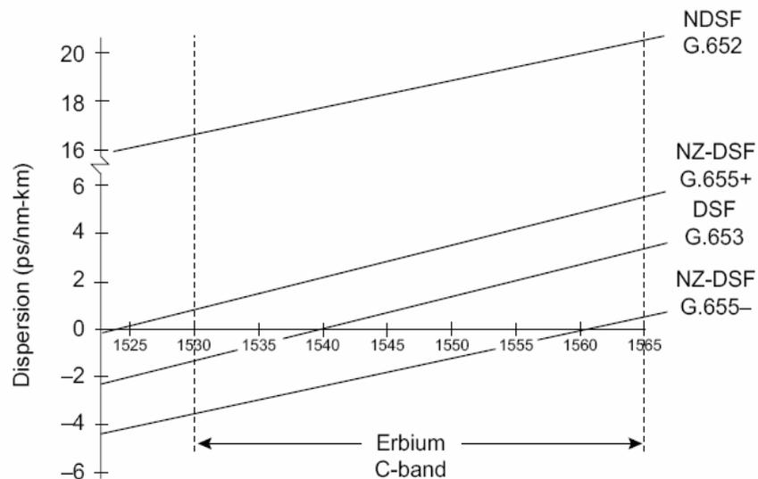
Рисунок 3.4 – Требования на уровень дисперсии в ОВ различного типа
