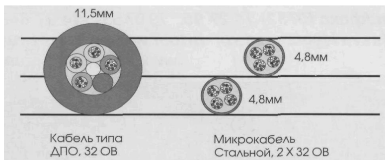
Рис. 2.16 – Преимущества миниатюризации. Кабель типа ДПО (слева) для задувки в ЗПТ и кабель "Стальной" для задувки в микротрубку
