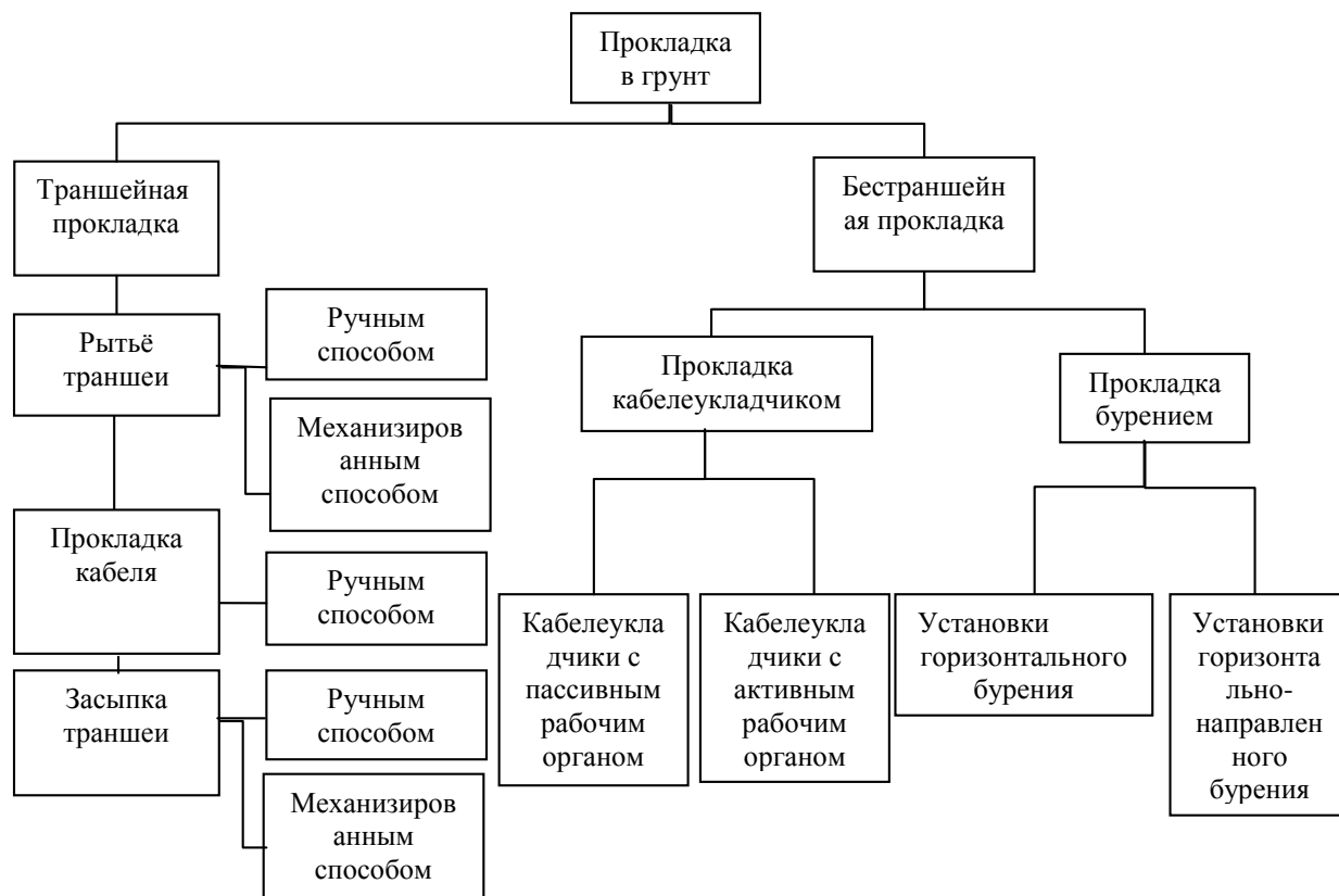
Рис. 2.4 – Способы прокладки полиэтиленовой трубы
