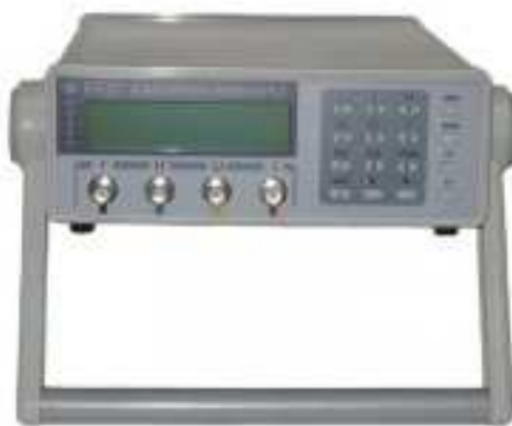
Рисунок 4. – Измеритель RLC E7-21
