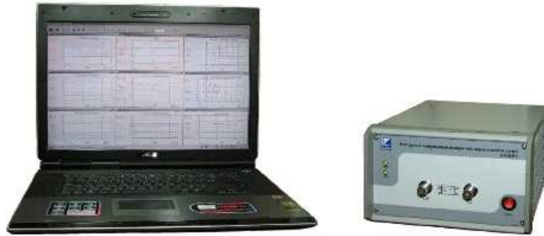
Рисунок 5. – Векторный импульсный измеритель характеристик цепей Р4-И-01
