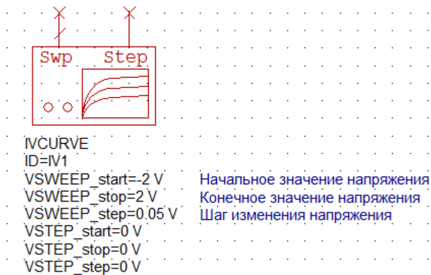
Рисунок 2.13 – Настройки модели источника постоянного напряжения
