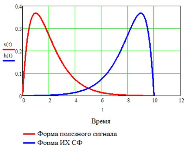
Рис. 1 – Пример входного сигнала и ИХ согласованного фильтра
