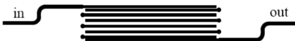
Рис. 6.12. Топология полосопропускающего (1 ГГц) фильтра на подложке RT/Duroid 5880 с параметрами: \epsilon_r=2,2 ; h=0,5 мм; t=35 мкм; \tan\delta=0,0009
