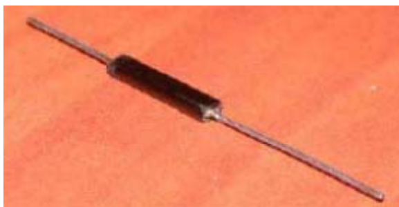
Рис. 6.11. UG-фильтр в выводном ( a ), проходном ( б ) исполнении
