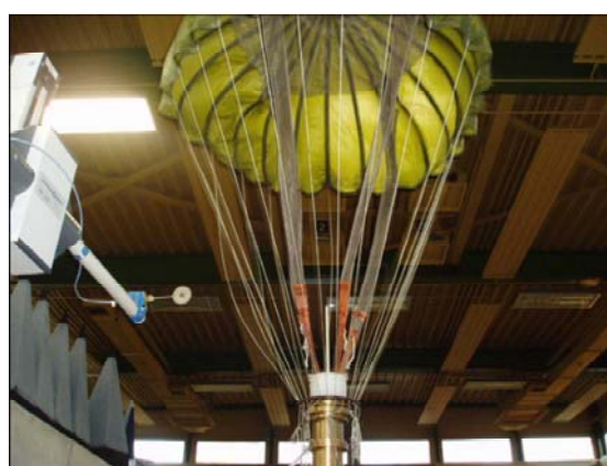
Рис. 3.4. Испытательная установка ( a ) для парашютной импульсной излучающей антенны ( б )
