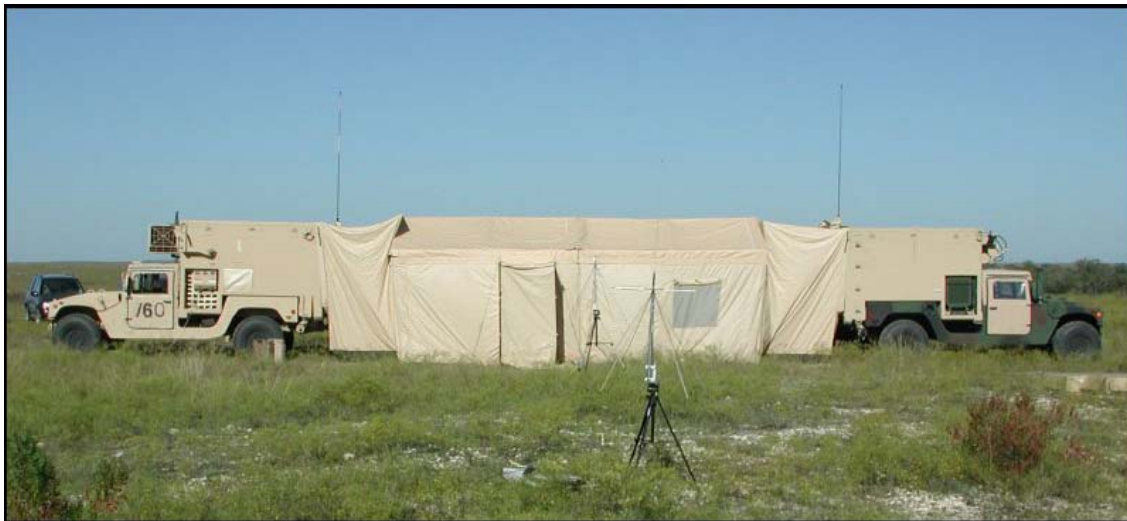
Рис. 6.10. Испытание электромагнитными помехами модульных тентов из проводящей ткани
