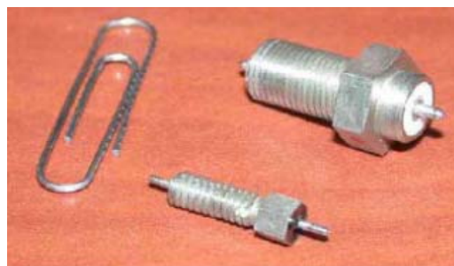
Рис. 6.11. UG-фильтр в выводном ( a ), проходном ( б ) исполнении
