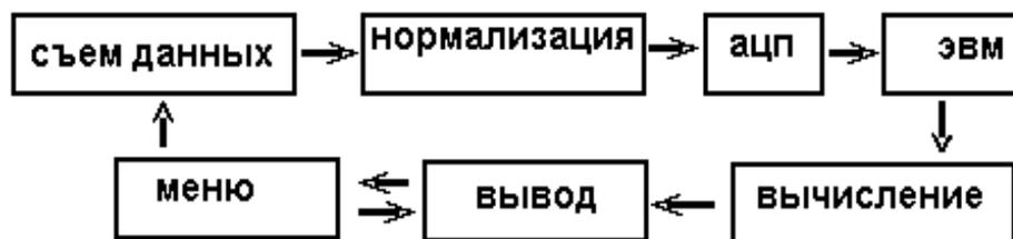
Рисунок 8.1 – Блок схема обработки данных с применением ЭВМ
