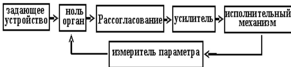
Рисунок 8.4 – Общая схема регулирования технологического процесса
