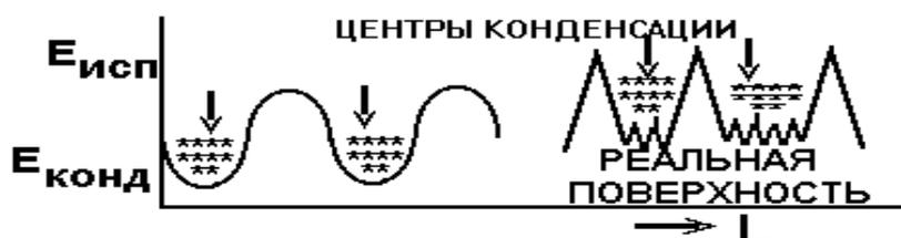
Рисунок 4.1 - Потенциальная диаграмма и фрагмент реальной поверхности
