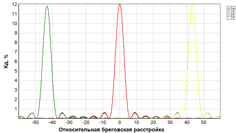
Рисунок 3.6 – Изменение дифракционной эффективности \eta_d решетки при отклонении от условий Брэгга с учетом оптимального времени, заданного вручную
