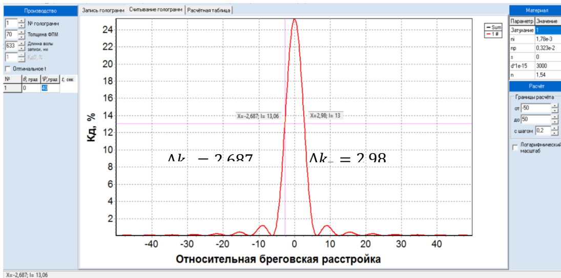
Рисунок 3.5 – Определение \Delta k по половинному уровню \eta_d при помощи курсора программы
