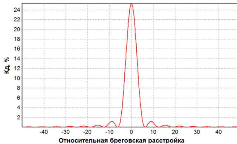
Рисунок 2.4 – Изменение дифракционной эффективности решетки \eta_d при отклонении от условий Брэгга
