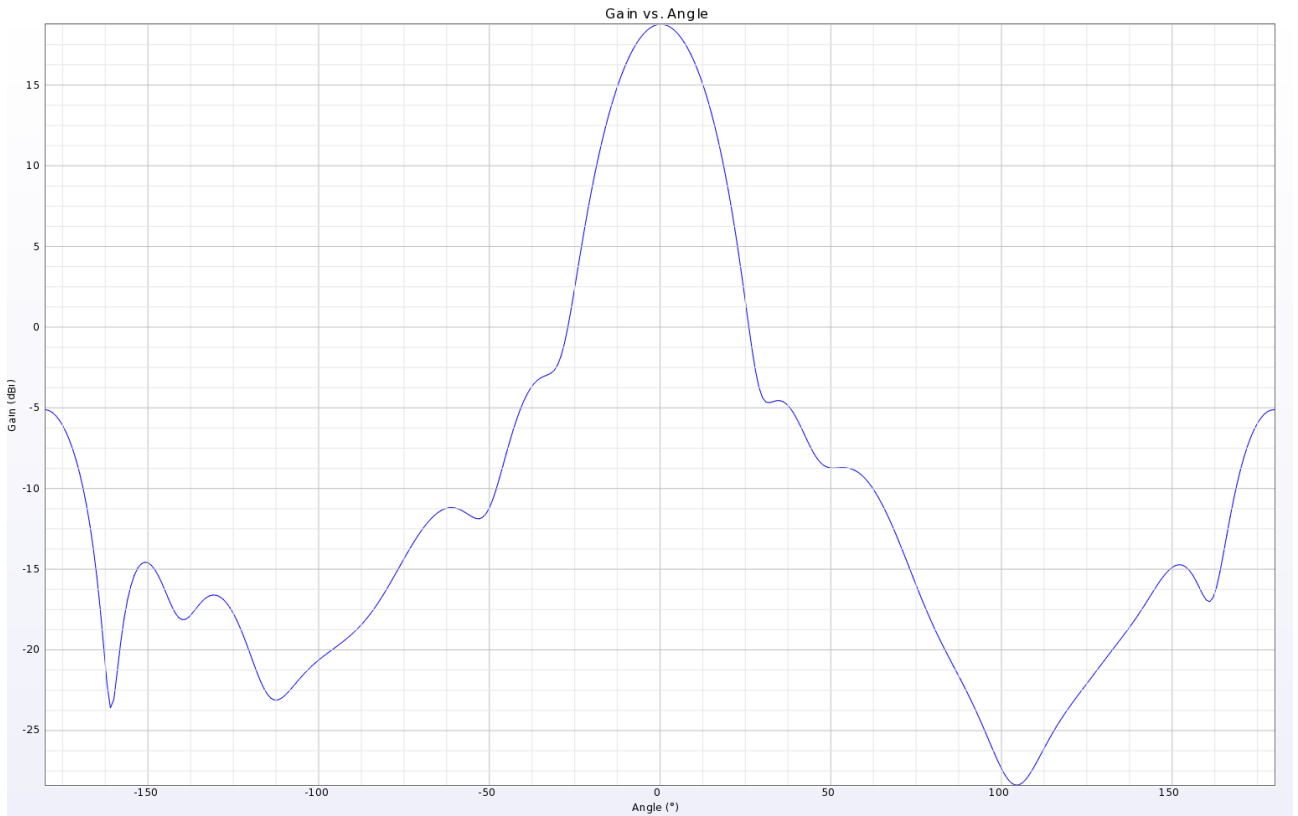
Рисунок 3.6 – Диаграмма направленности в H плоскости
