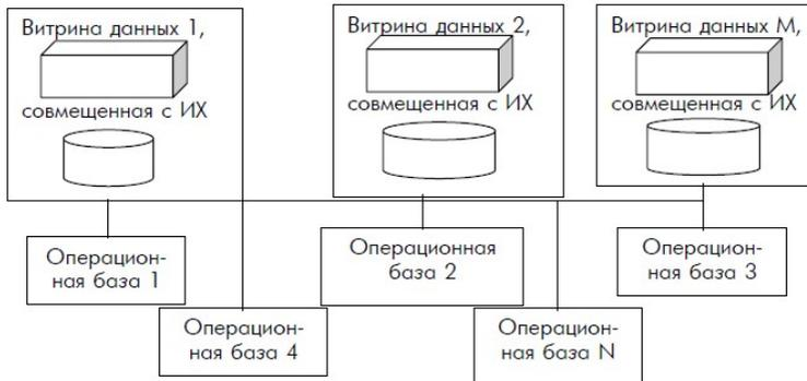
Рисунок 3.4 Схема автономных витрин данных
