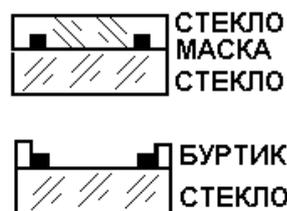
Рисунок 2.5 - Конструкция фотошаблона
