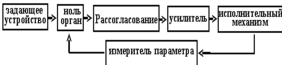
Рисунок 5.5 – Общая схема регулирования технологического процесса
