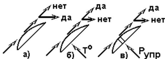
Рисунок 5.2 – а) - схема пассивного пневмоэлемента; б), в) - схемы активных пневмоэлементов
