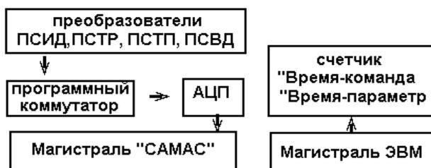
Рисунок 8.6 – Схема подключения датчиков к системе «КАМАК»
