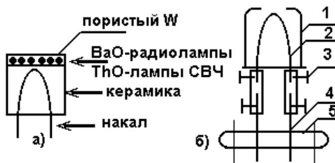
Рисунок 3.1 – Схема оксидного (а) и прямо накаленного (б) катода:
