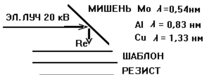
Рисунок 2.9 - Схема реализации рентгенолитографии
