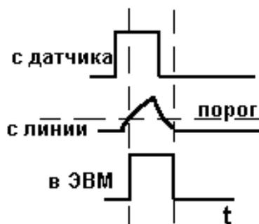
Рисунок 8.5 – Изменение сигнала во времени при передаче данных
