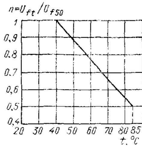
Зависимость коэффициентов снижения допустимой амплитуды напряжения переменной составляющей пульсирующего тока от температуры и частоты.
