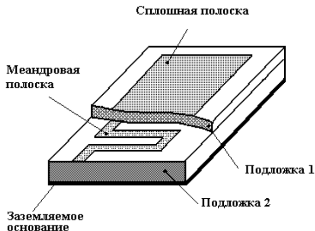
Рис. 1.9. Полосковые линии в виде сплошной полоски, связанной с меандровой полоской, отличающиеся сильной неуравновешенностью электромагнитной связи
