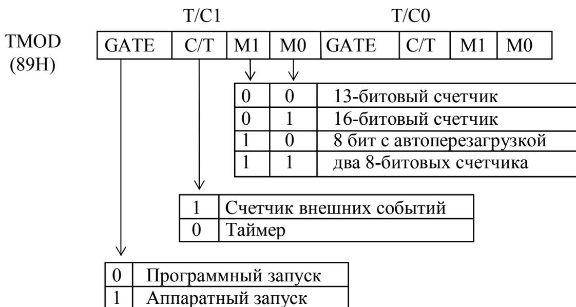
Рис. 4.1 — Формат управляющего слова таймеров
