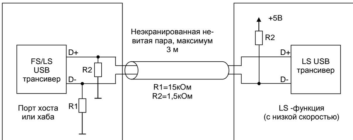
Рис. 10.4 — Подключение низкоскоростного устройства
