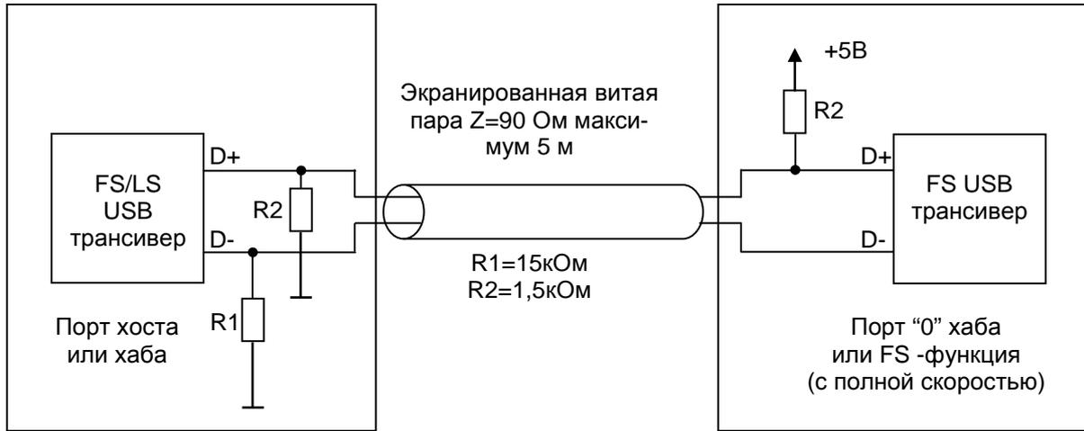
Рис. 10.3 — Подключение полноскоростного устройства
