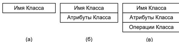
Рисунок 14 — Графическое представление класса на диаграмме
