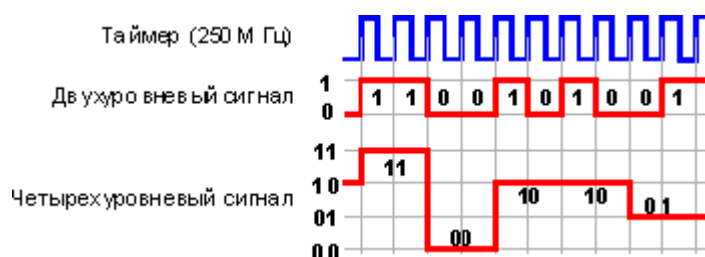
Рис. 5.26 — Схема 4-х уровневое кодирования PAM-4
