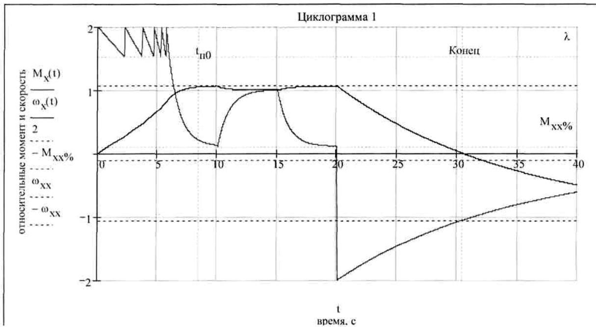
**Циклограмма для реостатного пуска и динамического торможения под нагрузкой**
