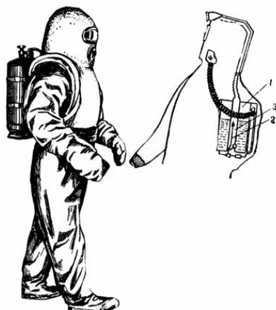
Рис. 8.4. Газотеплозащитный костюм для горноспасателей. Изобретение Г.С.Альтшуллера а.с. № 111 144
