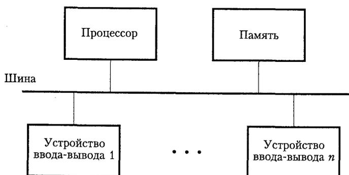
Рис. 6.1.1 – Архитектура системы с общей шиной
