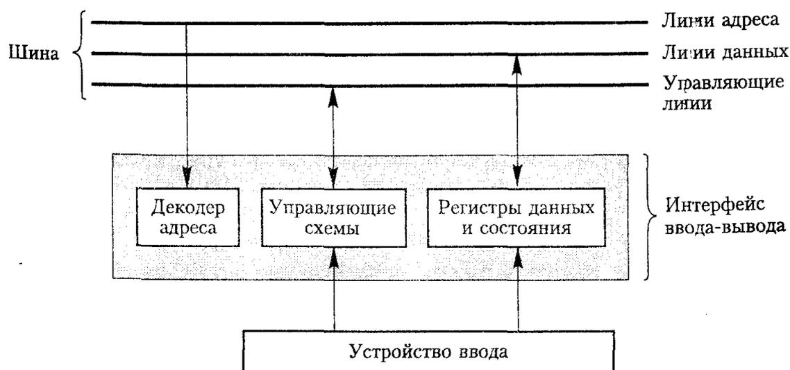
Рис. 6.1.2 – Интерфейс ввода-вывода для устройства
