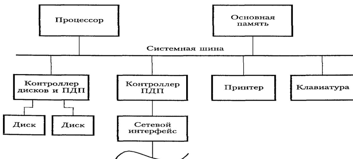
Рис. 6.3.2 – Использование контролеров ПДП в компьютерной системе
