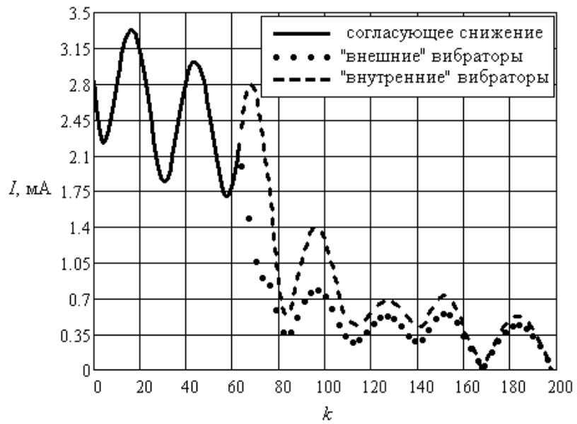
Рис. 3.9. Распределение токов в комбинированной антенне на частоте 15,75 МГц в зависимости от номера узла сетки
