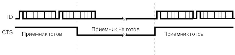
Рисунок 2.13 – Аппаратное управление потоком.
