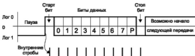
Рис. 2.12 – Формат асинхронной передачи RS-232C.
