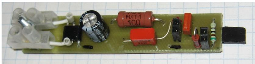
Рис.2. Конструкция генератора сверхкоротких импульсов на лавинном транзисторе со встроенным блоком питания от сети 220 В
