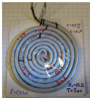
Рис.3. Конструкция отрезка линии передачи с волновым сопротивлением  $25 \text{ Ом}$  и режимом холостого хода на дальнем конце
