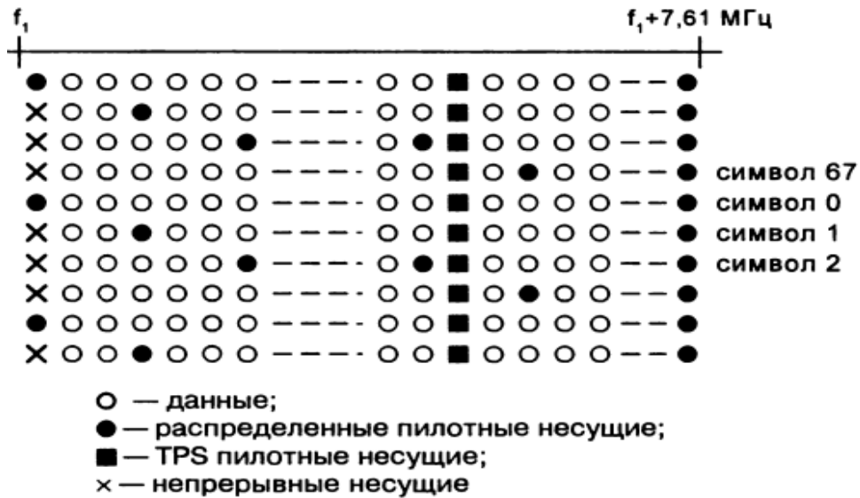
Структурная схема формирователя OFDM-символа в системе DVB-T
