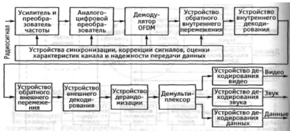
Структурная схема приемника системы DVB-T
