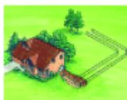
Тепловые насосы с горизонтальным теплообменником рассматриваются лишь при наличии поверхности необходимой площади. Замкнутый контур теплообменника укладывается горизонтально в глубокие траншеи, длина которых варьируется от 30 до 120 метров.
