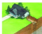
Замкнутый контур теплообменника устанавливается вертикально в подготовленные отверстия. Применяется в тяжелом грунте или при ограниченности пространства участка. Буровое оборудование используется для сверления отверстий малого диаметра на глубину 25-90 метров.
