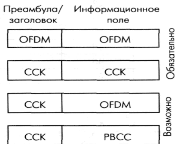
Рис. 5.11. Кадры IEEE 802.11g в различных режимах модуляции
