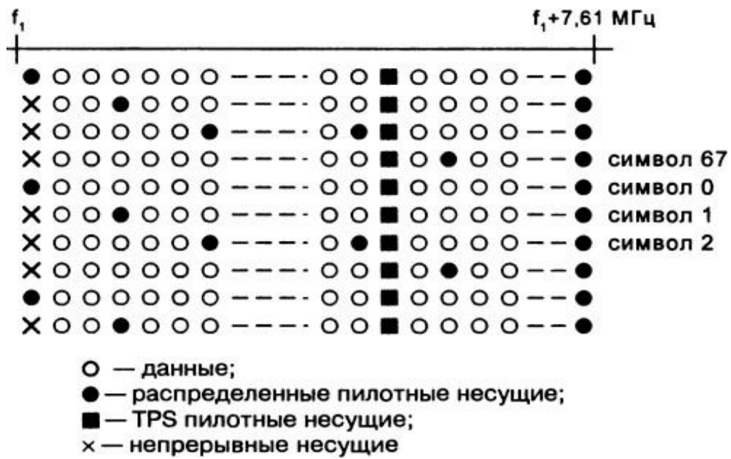
Рис. 10.12. Структурная схема формирователя OFDM-символа в системе DVB-T
