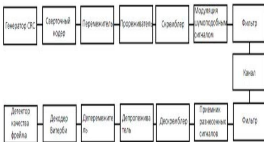
Рис. 4.18. Структурная схема CDMA
