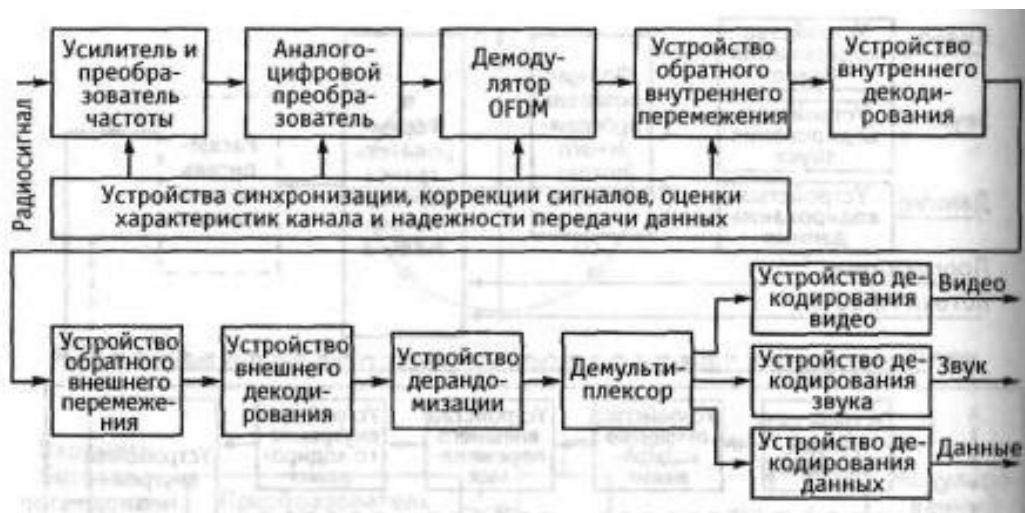
Рис. 10.2. Структурная схема приемника системы DVB-T
