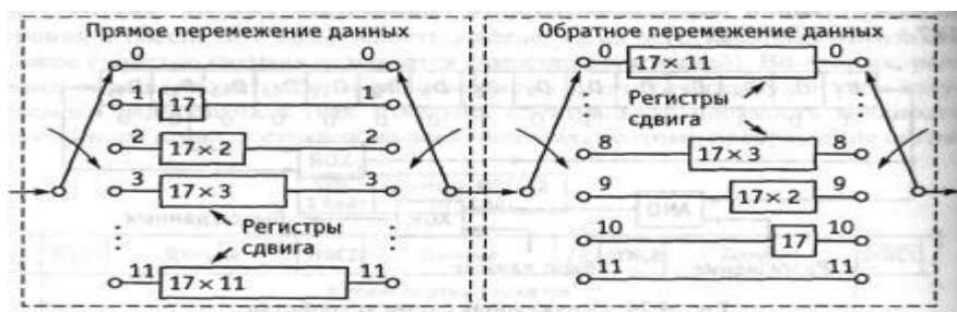
Рис. 10.6. Функциональная схема внутреннего перемежителя данных
