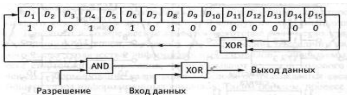
Рис. 10.4. Структурная схема устройства рандомизации данных
