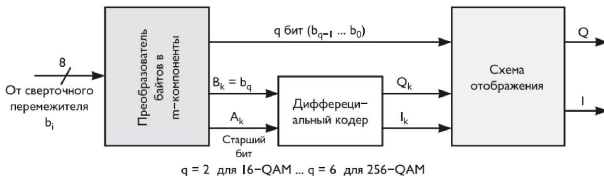
Рис. 12.2. Пример реализации преобразования байта в m -мерный вектор и дифференциального кодирования двух старших битов
