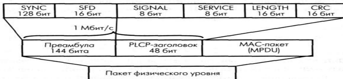
Рис. 5.4. Структура кадров сети IEEE 802.11b физического уровня
