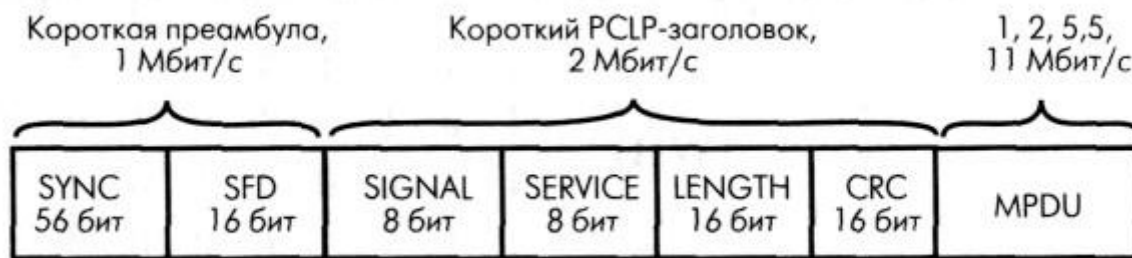
Рис. 5.5. Короткий заголовок кадров сети 802.11b
