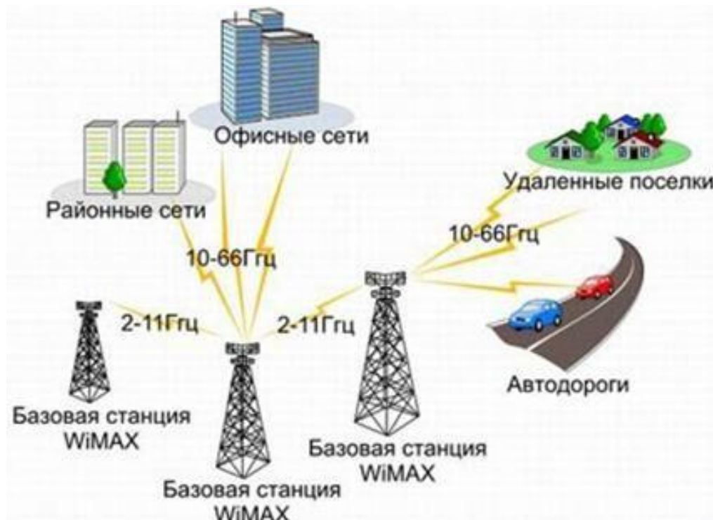
Рис. 8.4. Схематичное изображение сети WiMAX
