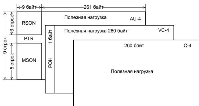
Рис. 1.2 – Структура модуля STM-1
