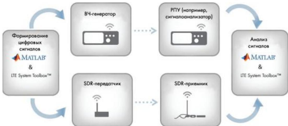
Рис. 2.11. Структурная схема программного комплекса
