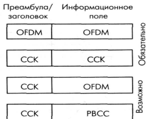
Рис. 7.56. Кадры IEEE 802.11g в различных режимах модуляции
