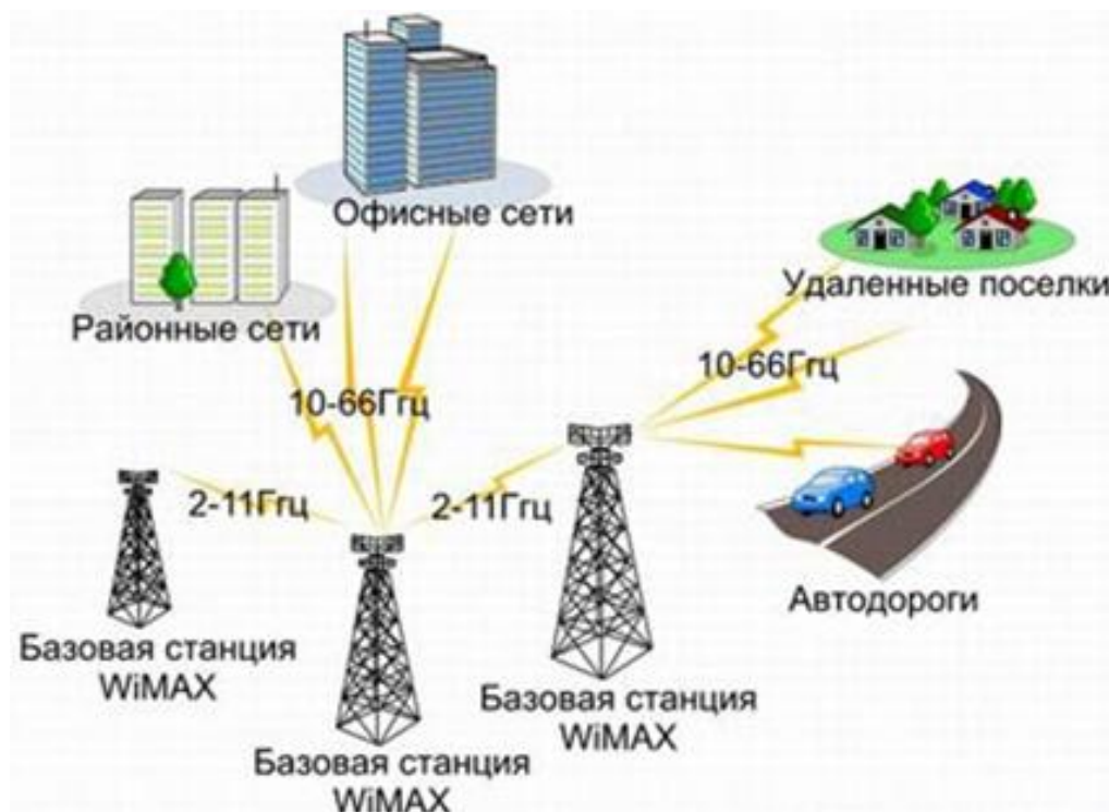
Рисунок 7.69 – Схематичное изображение сети WiMAX
