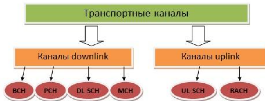
Рис. 7.125. Транспортные каналы LTE
