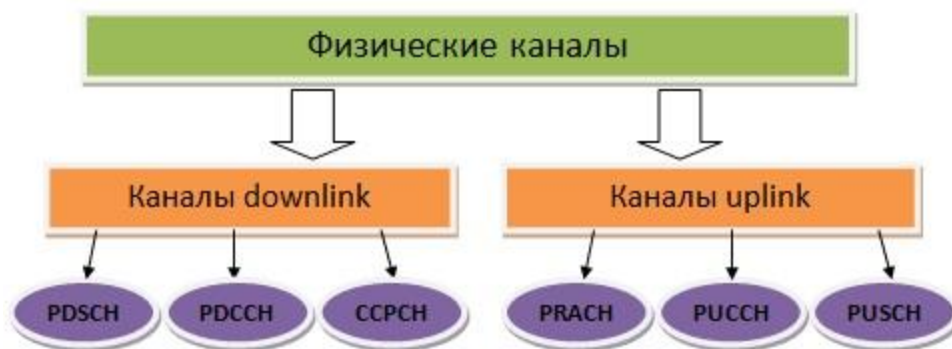
Рис. 7.127. Физические каналы LTE
