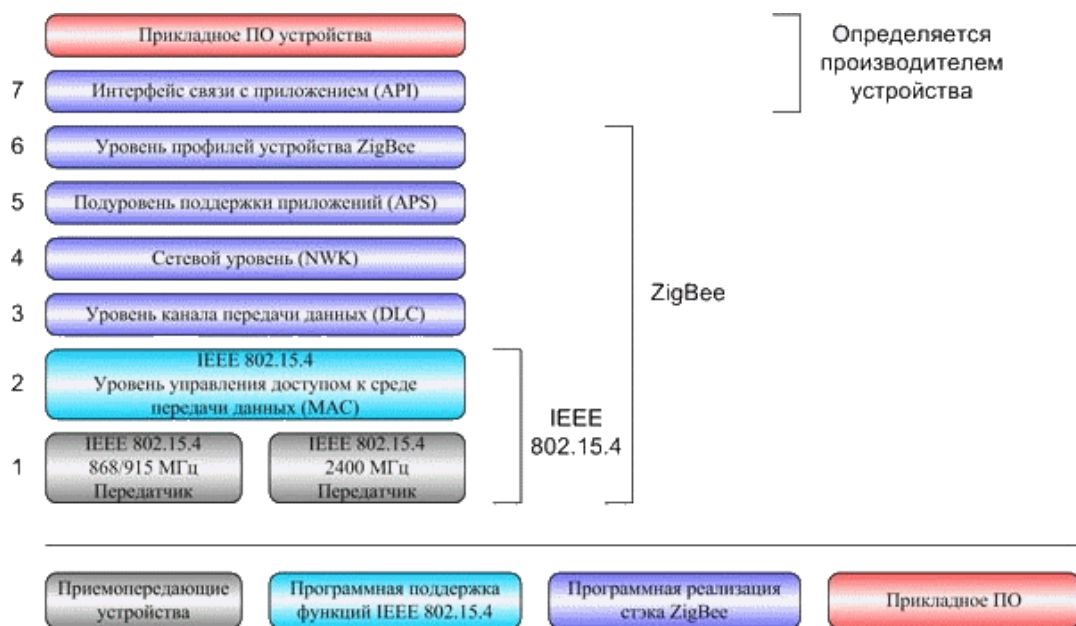
Рис. 7.68. Многоуровневая модель стандарта связи ZigBee
