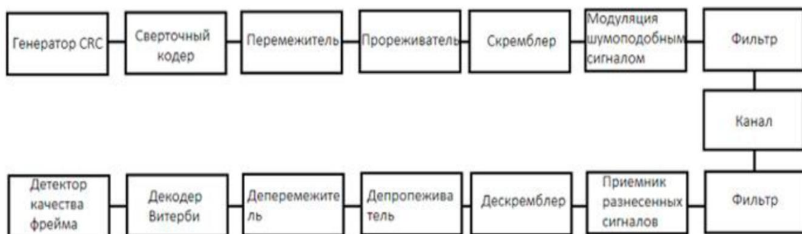
Рис. 7.18. Структурная схема CDMA
