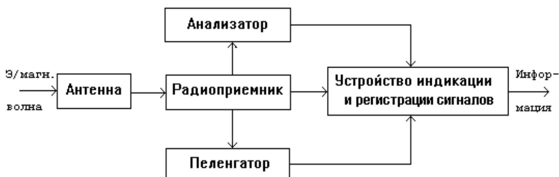
Рис. 3.8. Структура комплекса средств перехвата.
