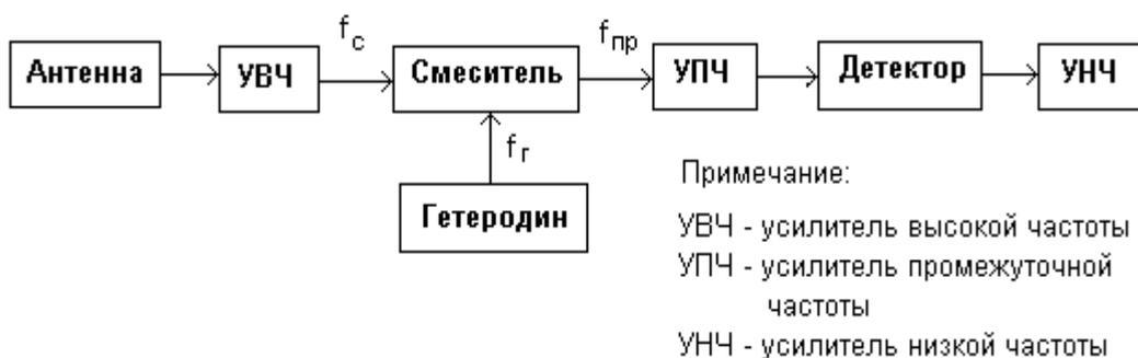
Рис. 3.11. Структура супергетеродинного приемника.
