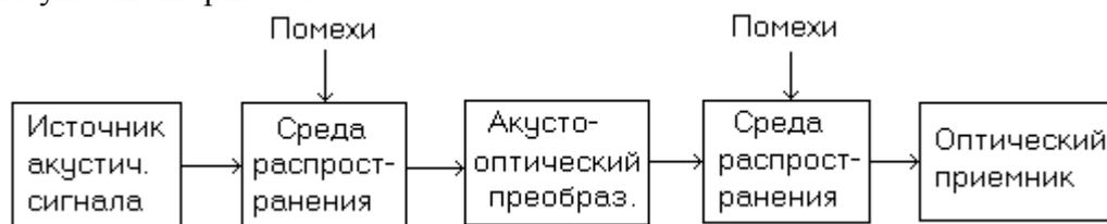
Рис. 4.8. Структурная схема акусто-оптического канала утечки информации,
