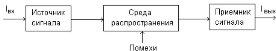
Рис. 4.1. Структура канала передачи информации.
