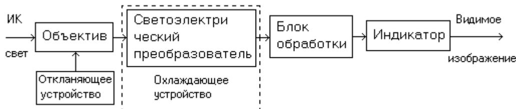
Рис. 3.3. Схема тепловизора.
