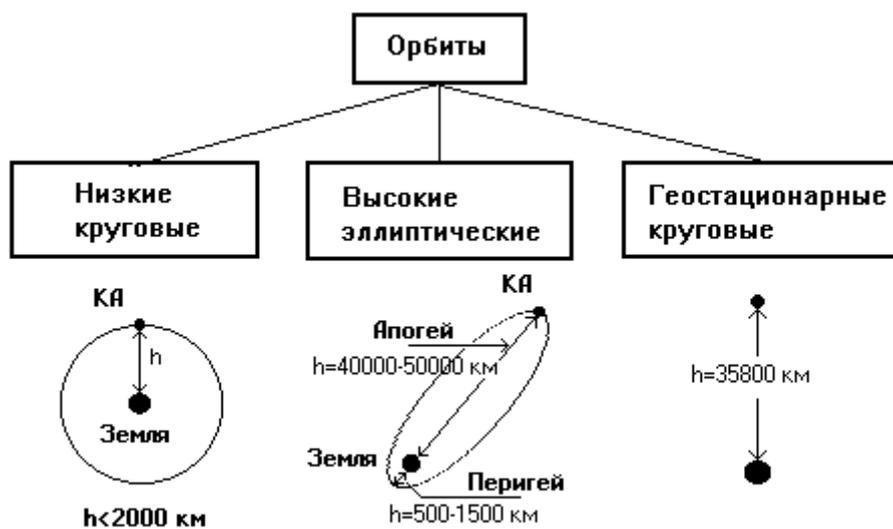
Рис. 2.5. Виды орбит разведывательных ИСЗ.
