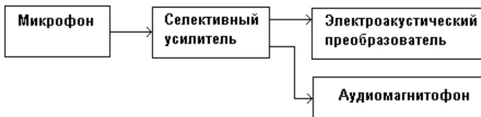
Рис. 3.12. Структурная схема акустического приемника.
