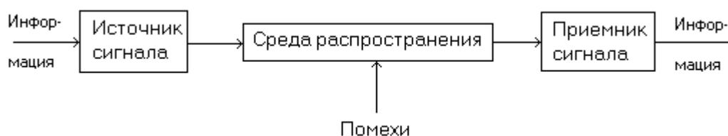
Рис. 4.4. Структура радиоэлектронного канала утечки информации.
