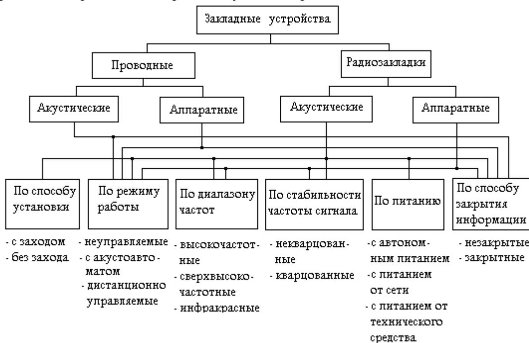
Рис. 3.14. Классификации закладных устройств.
