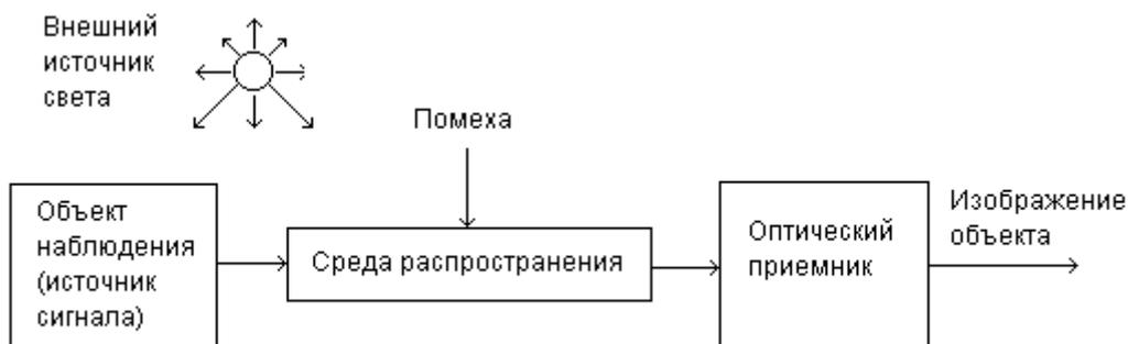
Рис. 4.3. Структура оптического канала утечки информации.
