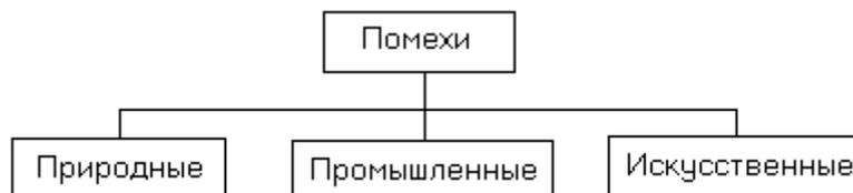
Рис. 4.5. Классификация помех в каналах утечки.
