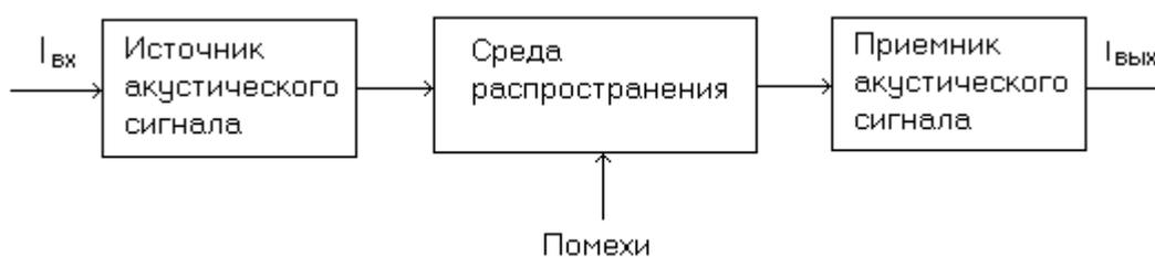
Рис. 4.6. Структура акустического канала утечки информации.
