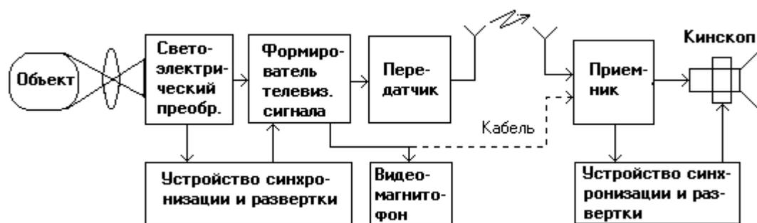
Рис. 3.4. Схема средств телевизионного наблюдения.
