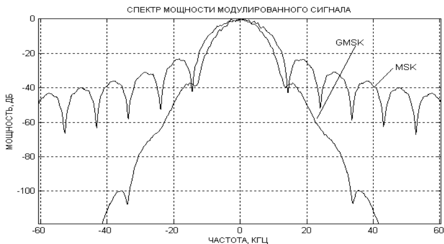
Рис. П1.12. Сравнение спектров двух видов модуляции с фильтром Гаусса(GMSK) и без фильтра(MSK)
