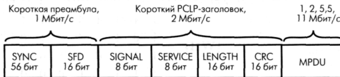
Рис. 7.50. Короткий заголовок кадров сети 802.11b
