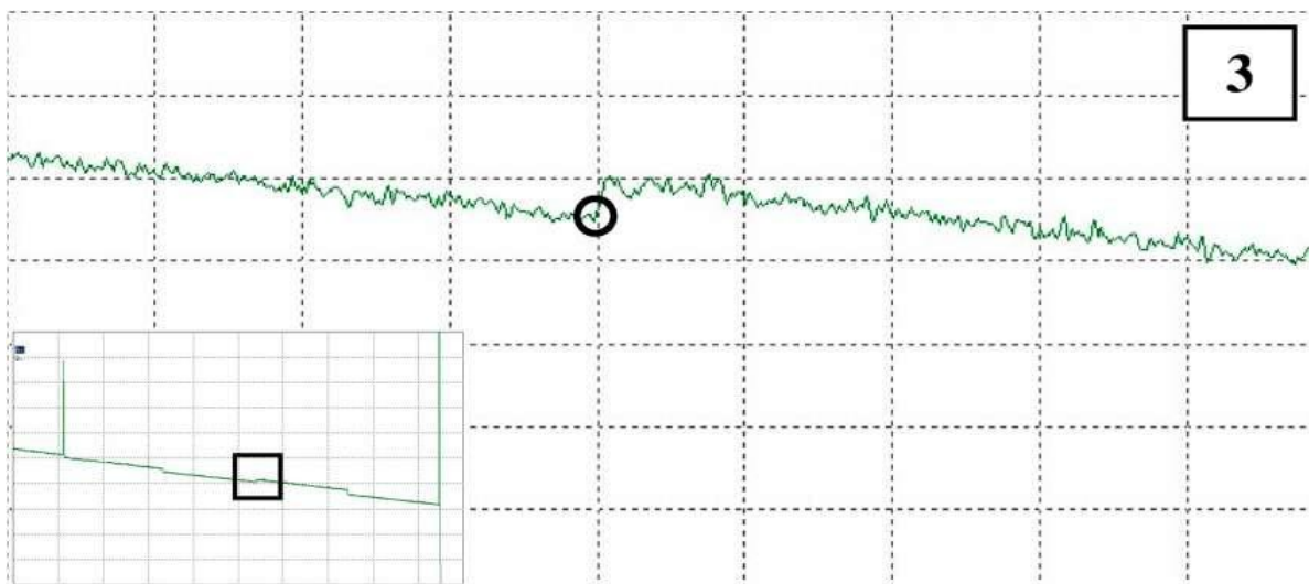
Рис. 4.23. неоднородность без отражения (сварное соединение - ступенька вверх)
