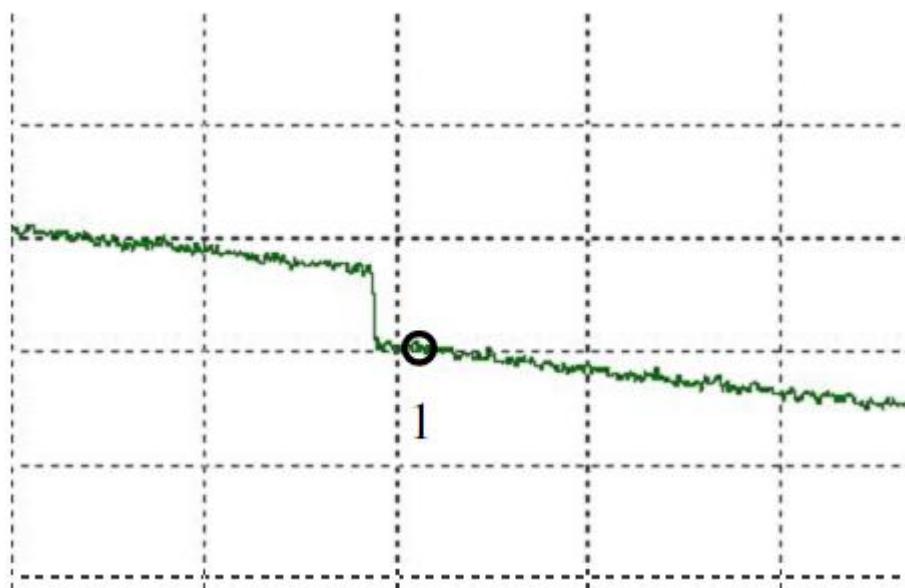
Рис. 4.50. Мертвая зона относительно неоднородности без отражения
