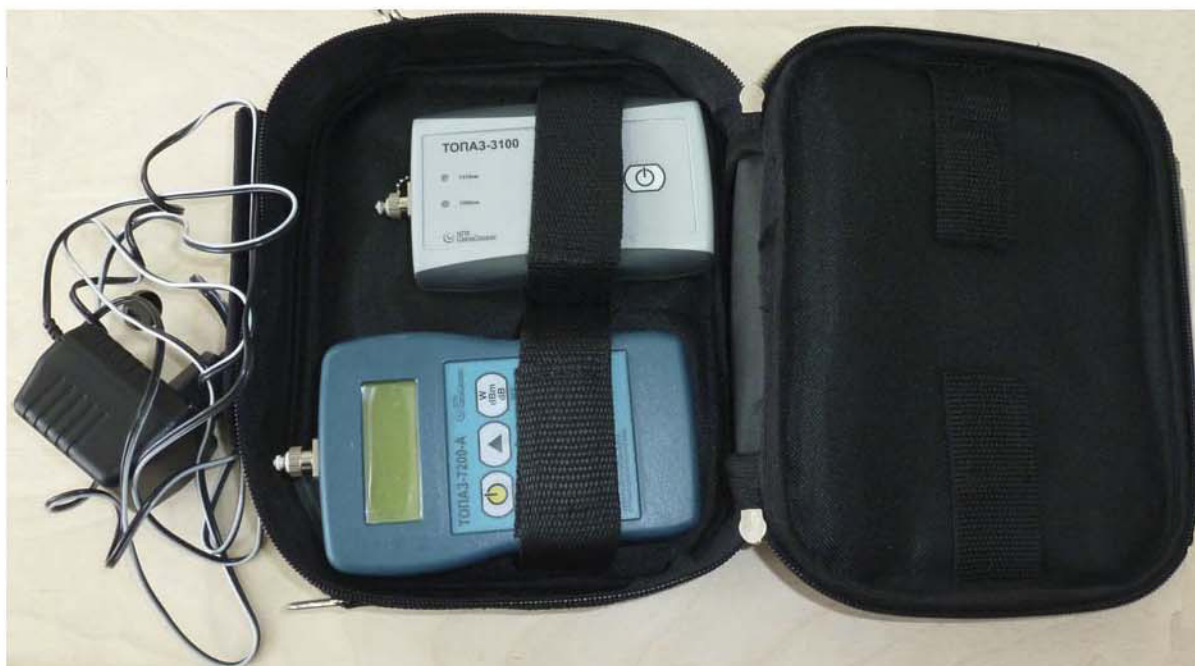
Рис. 6. Кейс с источником оптического излучения «Топаз 3105», измерителем оптической мощности «Топаз 7210А» и блоком питания «Топаз 7210А».
