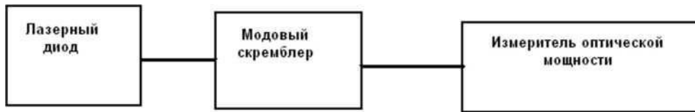
Рис. 5. Схема измерения ватт-амперной характеристики лазерного диода
