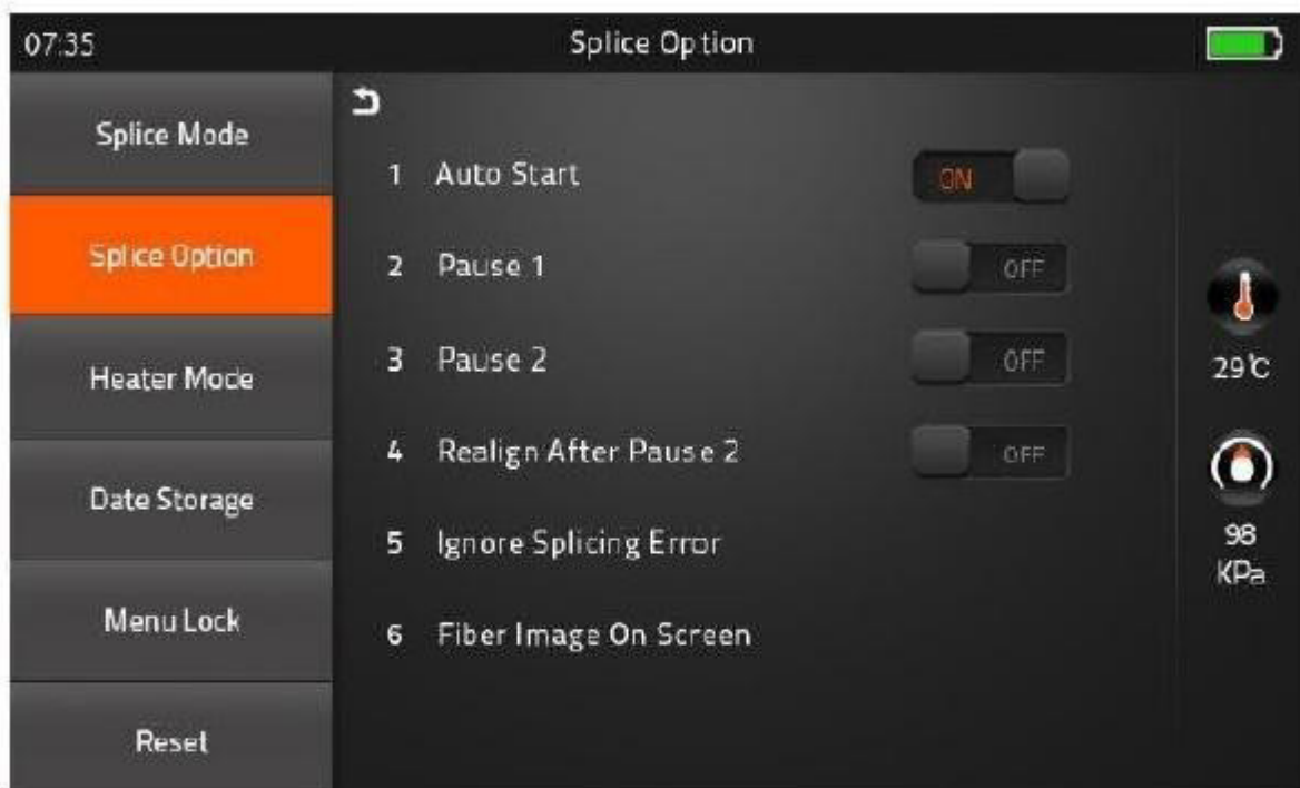
Рис.14 Опциональные настройки режимов сварки волокон.
