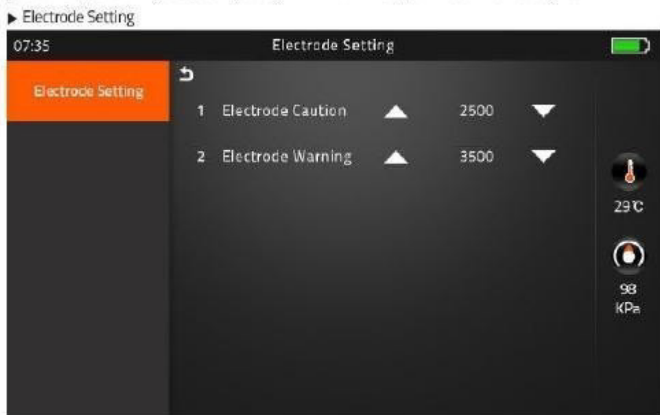
Рис.22 Настройка предупреждающих ограничений для электродов.
