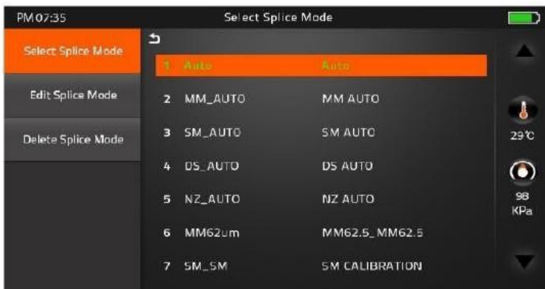
Рис.13 Общий вид интерфейса при выборе режима сварки для различных типов волокон.
