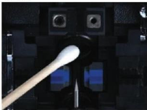
Рис.10. Место очистки линз и зеркал перед подготовкой к сварке.
