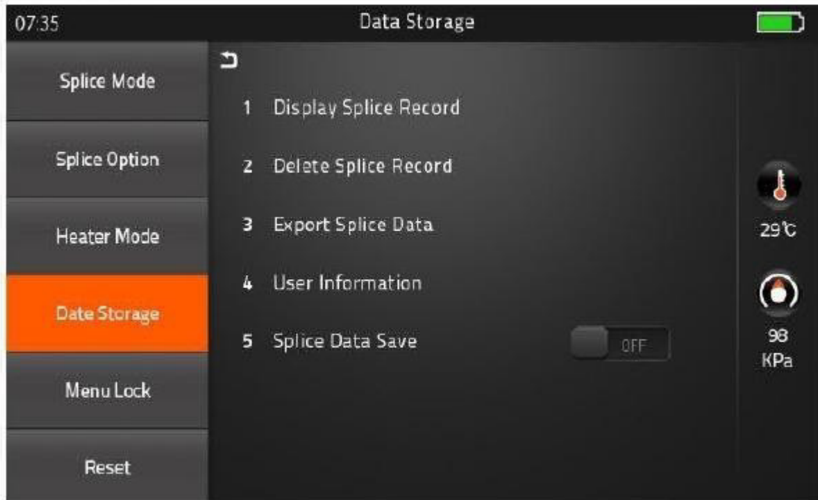
Рис.17 Интерфейс работы с записью текущих процессов сварки для последующей ее документации по требованиям СКК.
